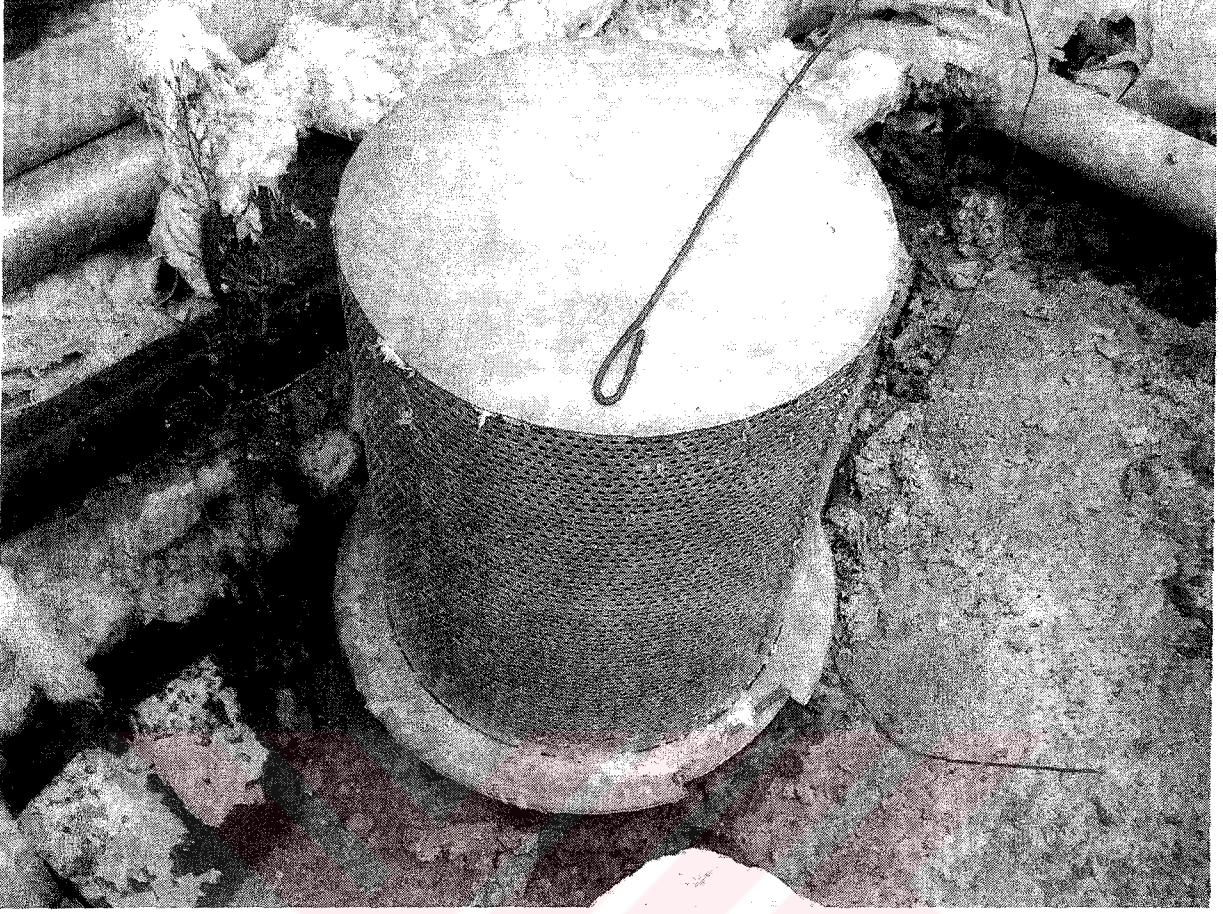
Şekil 5.17 Paslanmaz çelik eleğin havlardan temizlenmiş hali.
