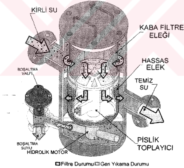
Şekil 4.1 Kendini temizleyen otomatik su filtresi.
