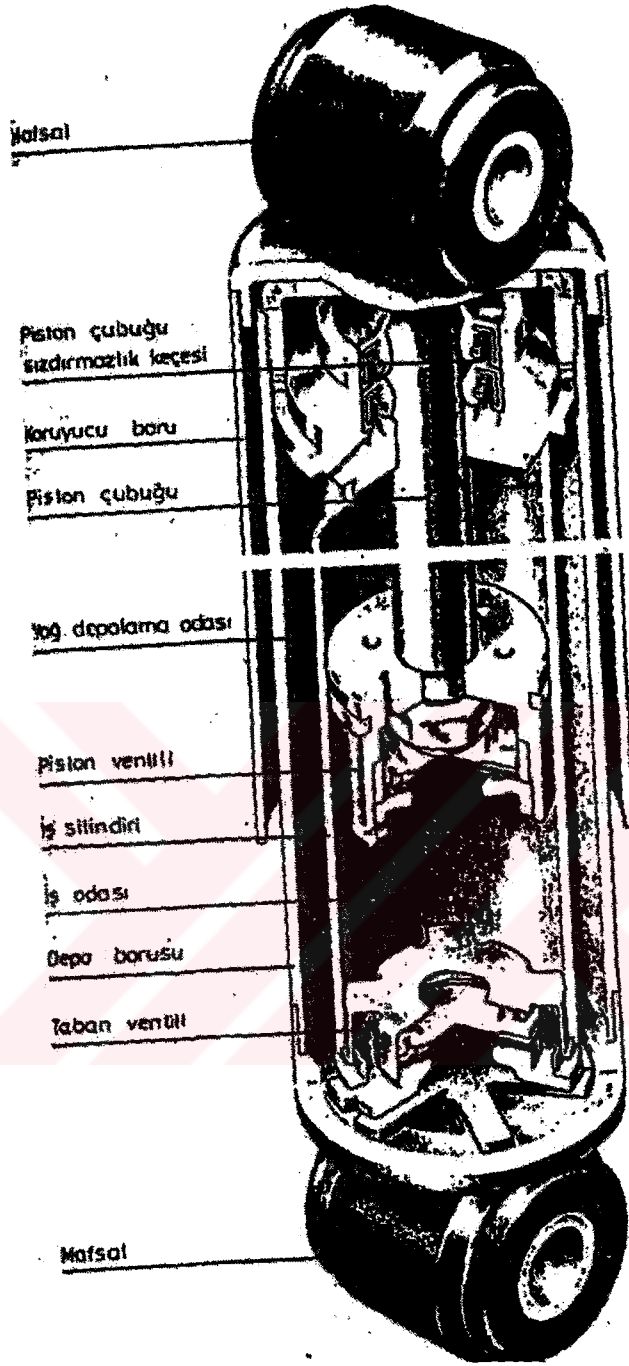
Şekil 4.18 Çift borulu amortisörün kesit resmi
