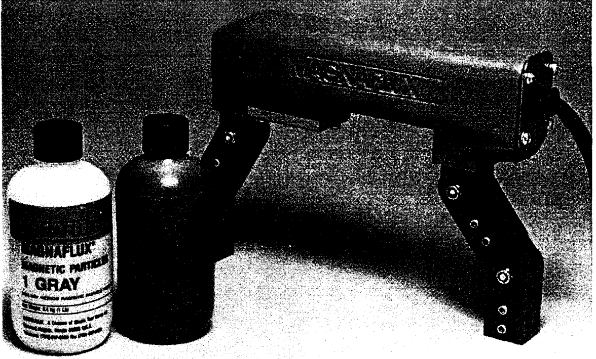
Şekil 7.3 Manyetik parçacık muayene cihazı ve ekipmanları (www.ndt-ed.org)
