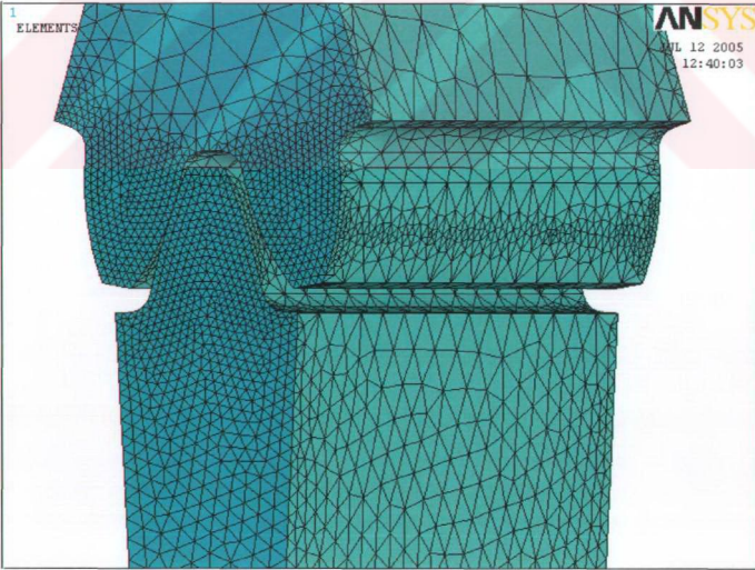
Şekil 7.3 Modelin free mesh ile sonlu elemanlara ayrılmış hali
