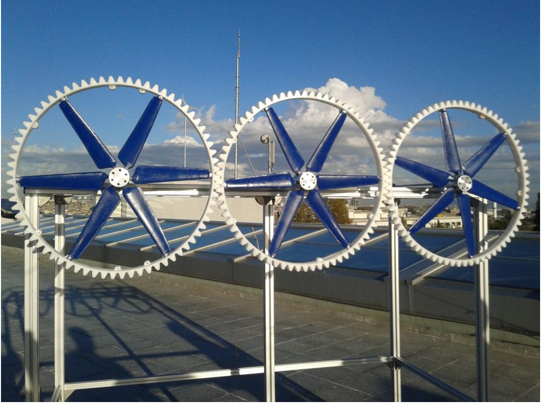
Şekil 6.16 Sistemin 6 kanatlı 3 dişli için montajlı durumu
