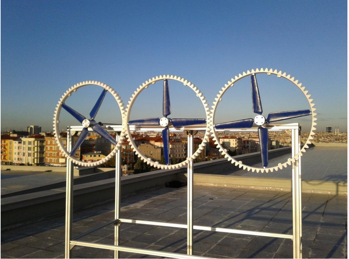
Şekil 6.17 Sistemin 4 kanatlı 3 dişli için montajlı durumu
