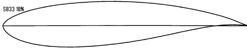
Şekil 6.5 S833 Kanat Profili
