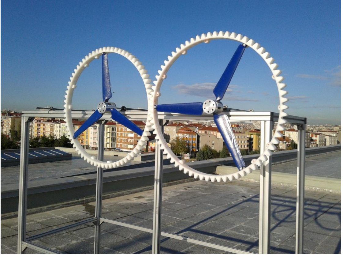
Şekil 6.18 Sistemin 3 kanatlı 2 dişli için montajlı durumu
