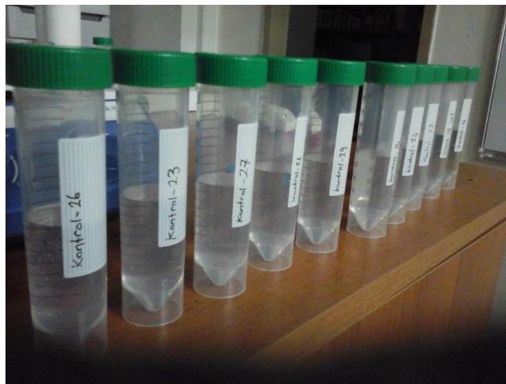
Şekil 4.8 Çözdürme işlemi sonrası falkon tüplere alınan, ICP-MS ve ICP-OES cihazlarında element tayinine hazır numuneler
