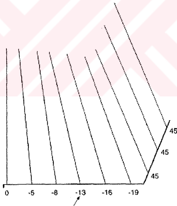
Çivilerin düşeyde eğimli tesis edilmesi (birimler derece)
