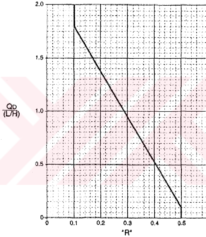
Şekil 5.6 Çivi boyunun duvar yüksekliğine bağlı olarak azaltılmasına ilişkin abak (FHWA-SA-96-069R, 1998)
