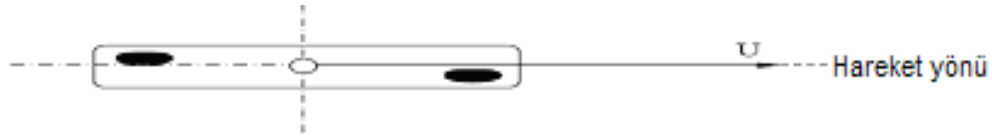
Şekil 2.1 Hareket yönünün lastik doğrusal düzlemi ile çakışması hali
