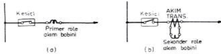
Şekil 5.3 Akım rölelerinin bağlantı şekilleri.
