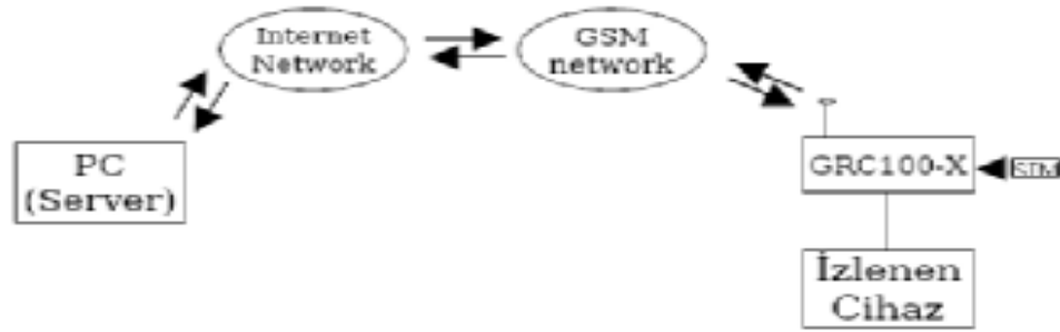
Şekil Ek 3.1 GPRS modülü prensip çalışma şekli.
