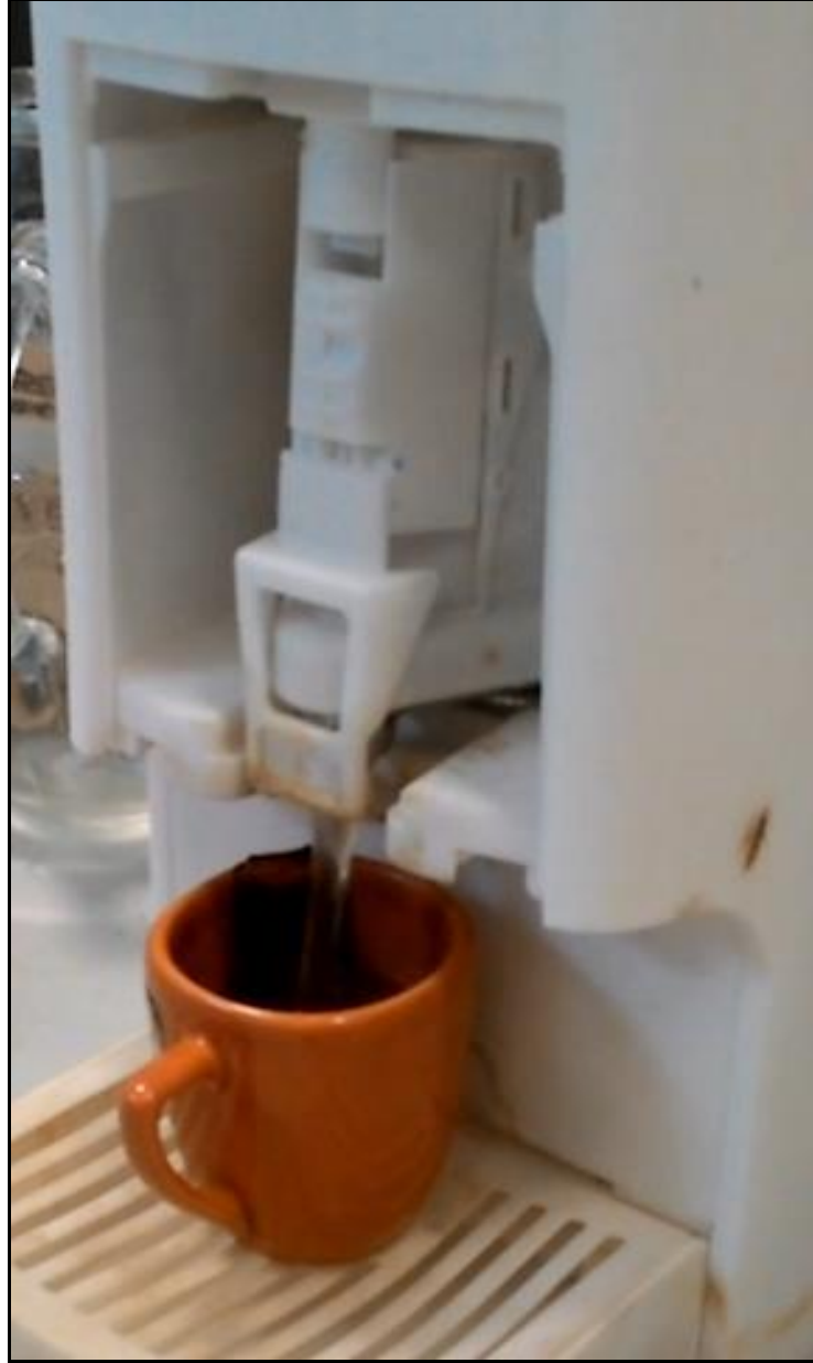
Şekil 5. 2 SLS yöntemi üretilen ürün ve piştirme haznesi
