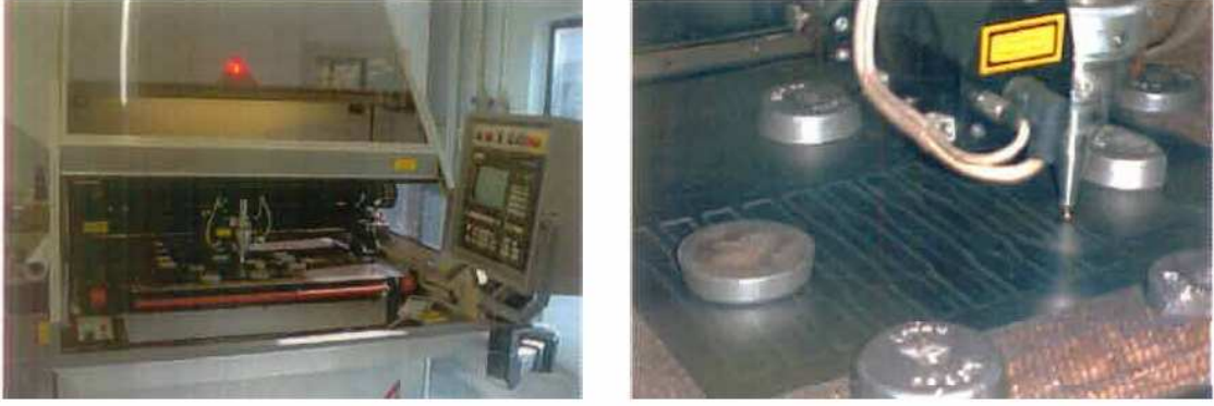
Şekil 8.3 Çekme numunelerinin çıkarılmasında kullanılan Alfa Laser kesme cihazı ( Arçelik A.Ş., 2008 )
