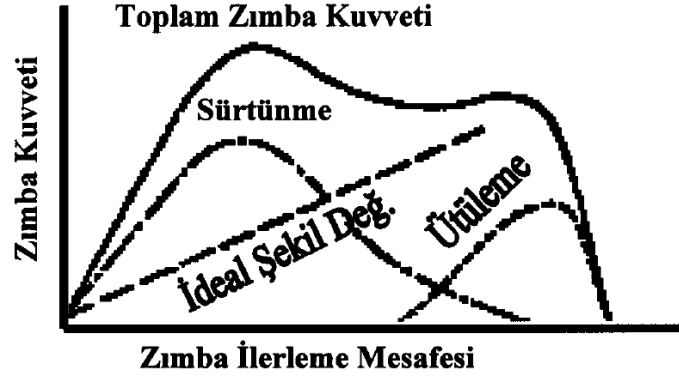
Şekil 5.34 Derin çekme işlemi esnasında uygulanan kuvvetin zımbanın ilerleme mesafesine göre değişimi ( Kayalı vd., 1979 )
