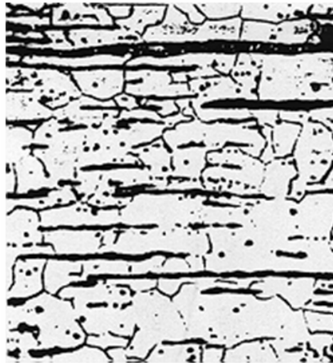
Şekil 6.13 Mekanik fiberleşme mikro yapısı ( Keeler vd., 1977 )
