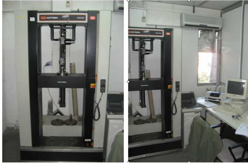
Şekil 7.5 Çekme deneylerinde kullanılan INSTRON 4505 üniversal çekme cihazı ( Arçelik A.Ş., 2008 )
