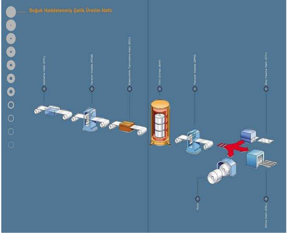
Şekil 3.8 Soğuk haddelenmiş çelik üretim hattı ( Kerim Çelik, 2007 )
