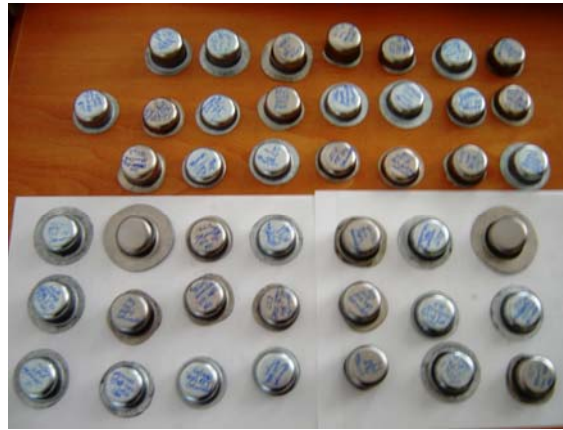
Şekil 8.36 Farklı pul çaplarına göre yapılan derin çekme testleri ( Arçelik A.Ş., 2008 )
