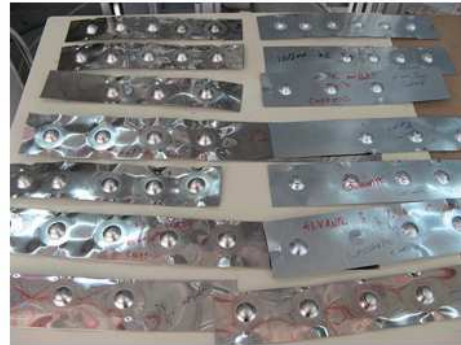
Şekil 7.23 Cupping test makinası ve test sonu numuneleri ( Arçelik A.Ş. )
