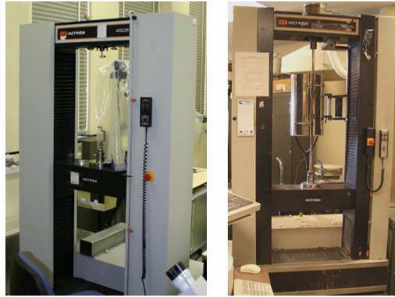
Şekil 8.4 Çekme deneylerinde kullanılan INSTRON 4505 universal çekme cihazı ( Arçelik A.Ş., 2008 )
