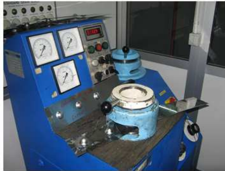
Şekil 7.23 Cupping test makinası ve test sonu numuneleri ( Arçelik A.Ş. )
