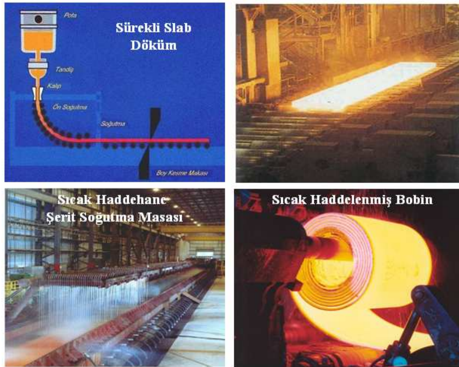
Şekil 3.2 Sürekli slab döküm ve sıcak haddeleme ünitesi ( Borçelik, 1999 )
