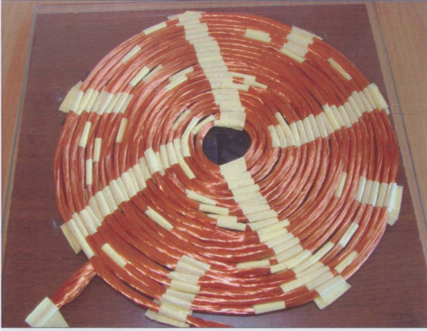
Şekil 7.3 Dizayn edilen asimetrik pancake bobin
