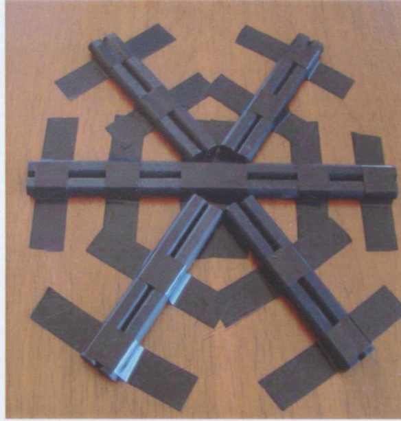
Şekil 7.2 Tasarımda ferit çubukların yerleştirilme geometrisi.
