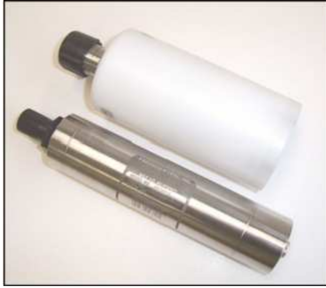
Şekil 2.2 Sualtı derinlik algılayıcı (Paroscientific 8000 serisi)
