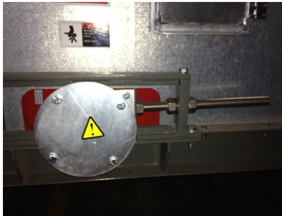
Şekil 3.32 Vidalı gergi tamburunun tek tarafında bulunan 'sıfır hız şalteri' [9]
