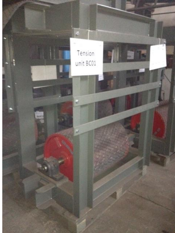
Şekil 3.33 Bandın alt koluna ağırlık sarkıtmada kullanılan sepet konstrüksiyonu [9]
