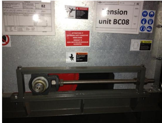
Şekil 3.31 Vidalı gergi tertibatı, gergi tamburu ve tambur muhafazası [9]
