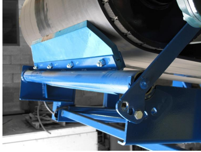
Şekil 3.26 Silgi tertibatının tambur üzerinde uygulaması
