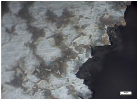
Şekil 7.30 250 °C'de T6 numune kopma bölgesi mikroyapı görüntüsü 100X büyütme
