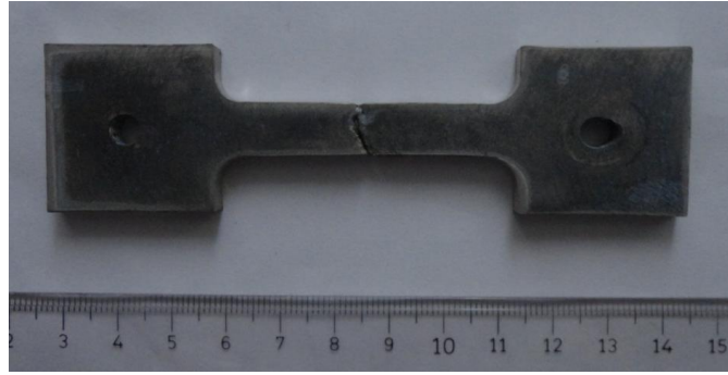
Şekil 7.43 400 °C’de homojenize numune sıcak çekme testi sonrası görüntüsü
