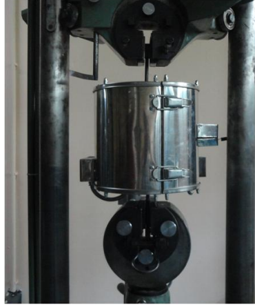
Şekil 6.11 Sıcak çekme deneyi öncesi numunenin ısıtılması
