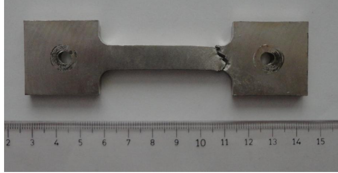
Şekil 7.31 350 °C’de döküm numune sıcak çekme deneyi sonrası görüntüsü
