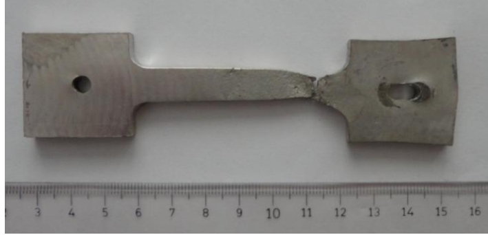
Şekil 7.40 400 °C’de döküm numune sıcak çekme deneyi sonrası görüntüsü
