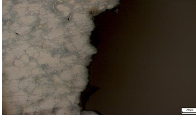
Şekil 7.36 350 °C’de homojenize numune kopma bölgesi mikroyapı görüntüsü 50X büyütme
