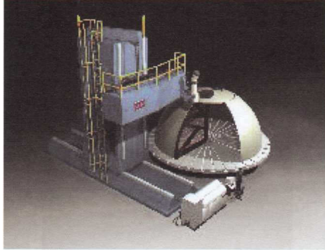
Şekil 4. 32 Lockheed Martin tarafından tasarlanan ve uzay roketlerinin silindirik uç kısımlarının kaynağı için geliştirilen sürtünme karıştırma kaynağı makinası eskiz görünümü
