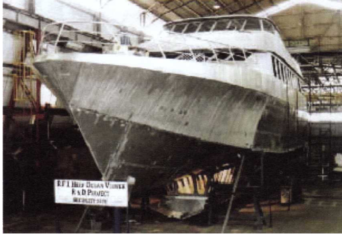
Şekil 4. 10 Avustralya ve Yeni Zelanda askeri tersanelerinde üretilen FSW kaynaklı 55 m boyundaki karakol gemisi
