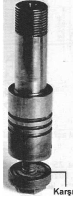
Şekil 4. 39 Altlık kullanımını ortadan kaldırmak amacı ile karşı omuzlu olarak tasarlanmış bobin ya da makara biçimli (bobbin) takım
