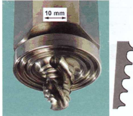
Şekil 4. 38 TWI tarafından geliştirilen kesik koni helisel pimin üç kanallı olduğu MX-Triflute™ takımı
