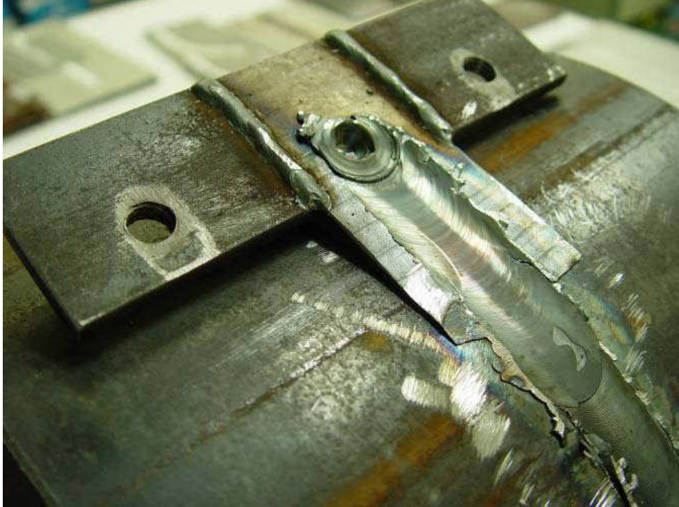
Şekil 5. 10 SKK'da takım çıkış noktasındaki yarığı önlemek için alınan önlem.
