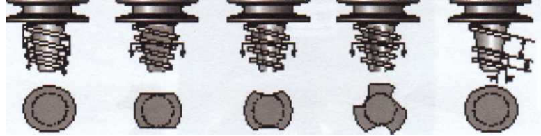
Şekil 4. 37 Çeşitli pim profillerinde üretilen Whorl™ takımlar
