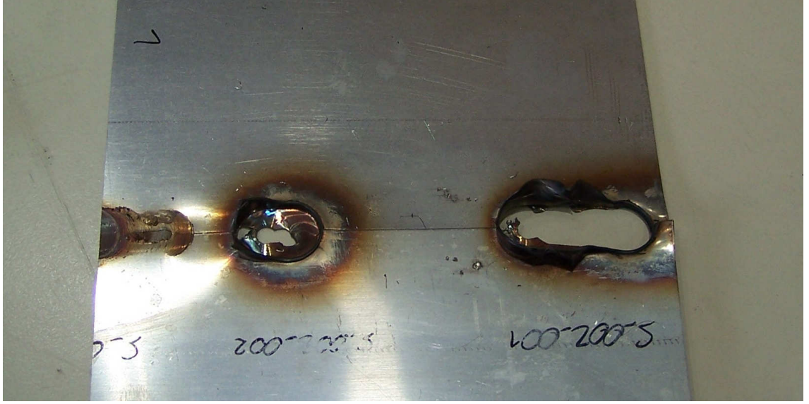
Şekil 6. 9 Çelik sacın, 400 dev/dk devir sayısı 50 mm/dk ilerleme hızı ve 24 kN baskı kuvveti parametreleri ile yapılan sürtünme karıştırma kaynağı
