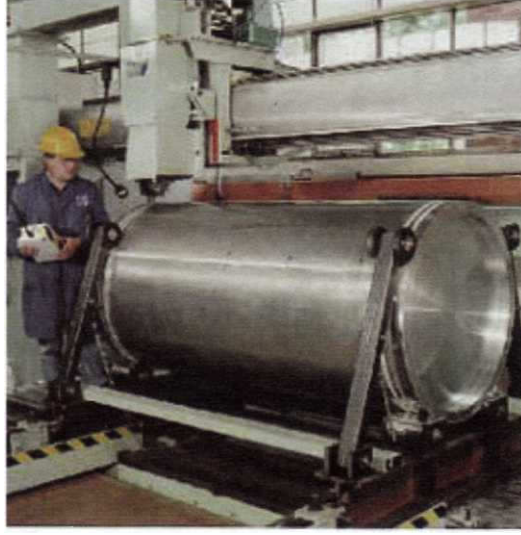
Şekil 4. 22 TWI tarafından İngiltere'de FSW yöntemi kullanılarak üretilen ilk roket yakıt tankı
