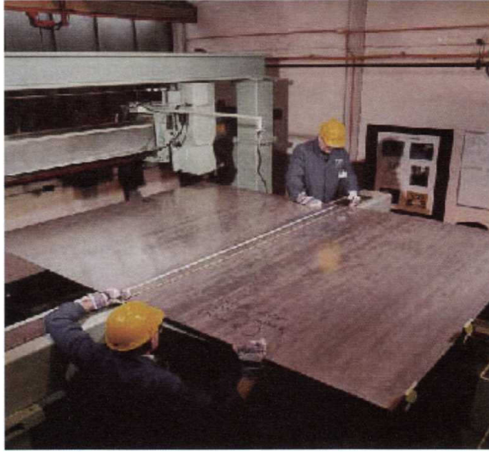
Şekil 4. 29 Bir İsveç kuruluşu tarafından geliştirilmiş sabit yataklı sürtünme karıştırma kaynağı makinası
