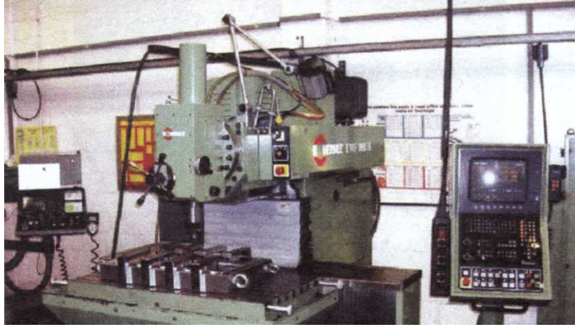
Şekil 4. 27 Avrupa'da sürtünme karıştırma kaynağı uygulamaları için lisans alınarak modifiye edilmiş FSW makinası
