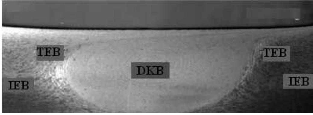
Şekil 4. 5 AA 7075 çiftinin kaynak sonrası mikro yapısal bölgeleri
