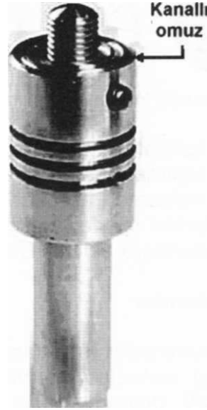
Şekil 4. 35 Vidalı pim boyunun ayarlanabildiği dairesel kanallı omuza sahip basit bir vida pimli takım
