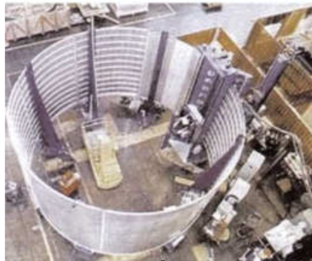
Şekil 4. 25 NASA için FSW yöntemi ile üretilen uzay aracı roket gövde ve yakıt tanklarının üretiminde kullanılan sistemler
