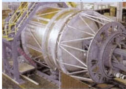
Şekil 4. 24 Uzay mekiklerinin roketlerinin FSW yöntemi kullanılarak üretilmiş yakıt tankı
