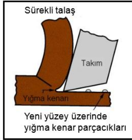
Şekil 2.8 Yığma talaş (YT) [61]
