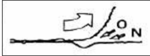
Şekil 3.4 Oksidasyon aşınması mekanizması [39]
