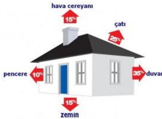
Şekil 2.11 Bir konutta ısı enerjisi kayıplarının gerçekleştiği bölgeler ve oranları (İ-T)
