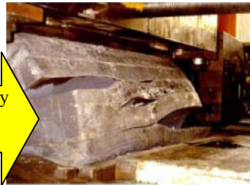
Şekil 4.3 Kauçuk tabakalı yalıtkanın deformasyonu (Saito, 2005).
