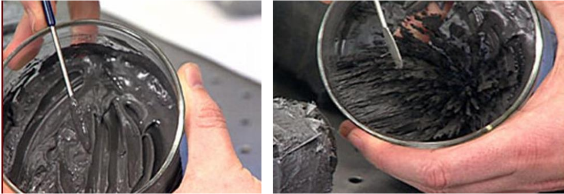
Şekil 3.43 MR sıvıda manyetik alanın varlığına ve yokluğuna göre hareketi [38].
