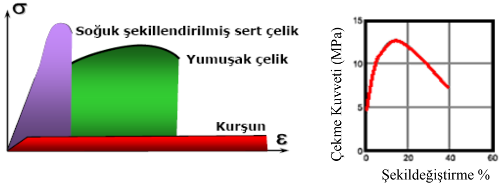
Şekil 4.45 Kurşunun çekme kuvveti ile gerilme-şekildeğiştirme grafikleri [55].
