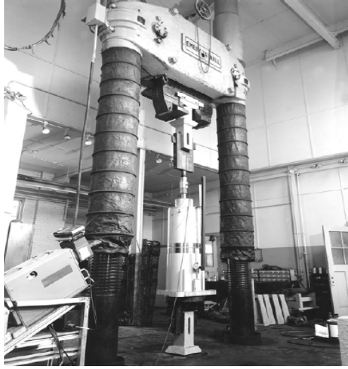
Şekil 3.3 ABD Hava Kuvvetlerinde test edilen 200 tonluk viskoz akışkanlı sönümleyici (Taylor ve Duflo, 2003).
