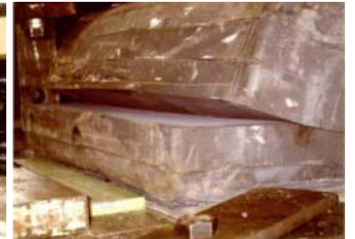
Şekil 4.3 Kauçuk tabakalı yalıtkanın deformasyonu (Saito, 2005).
