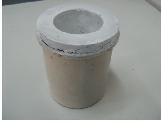
Şekil 5.1 Ergitme deneylerinde kullanılan bor nitrür kaplı grafit pota.
