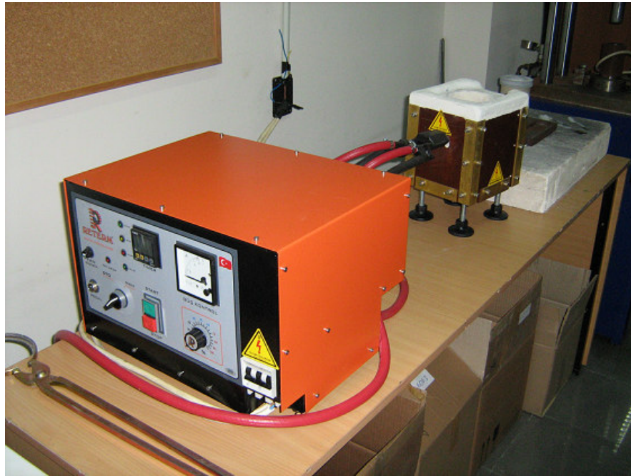
Şekil 5.2 Ergitme deneylerinde kullanılan induksiyon fırını.
