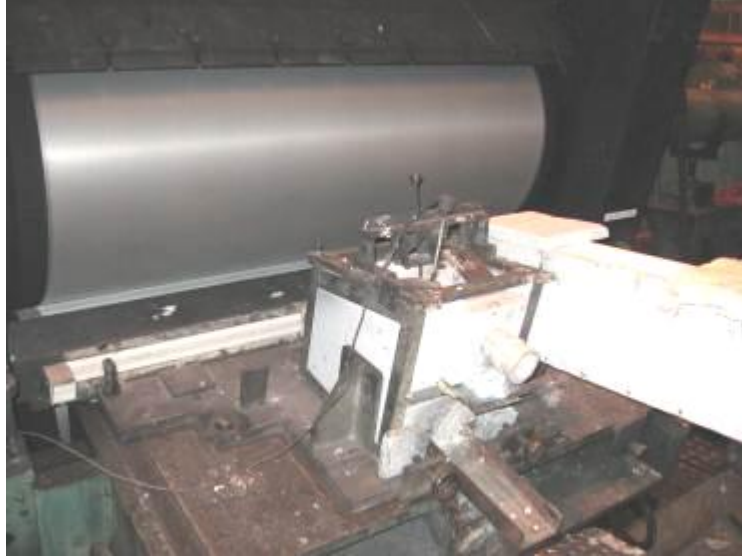
Şekil 3.7 Assan Alüminyum 5.Döküm Hattında kullanılan seramik tip ve baş kutu
