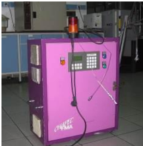
Şekil 6.1 FMA Hidrojen Analiz Ünitesi ve Ölçüm Probu
