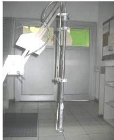
Şekil 6.1 FMA Hidrojen Analiz Ünitesi ve Ölçüm Probu
