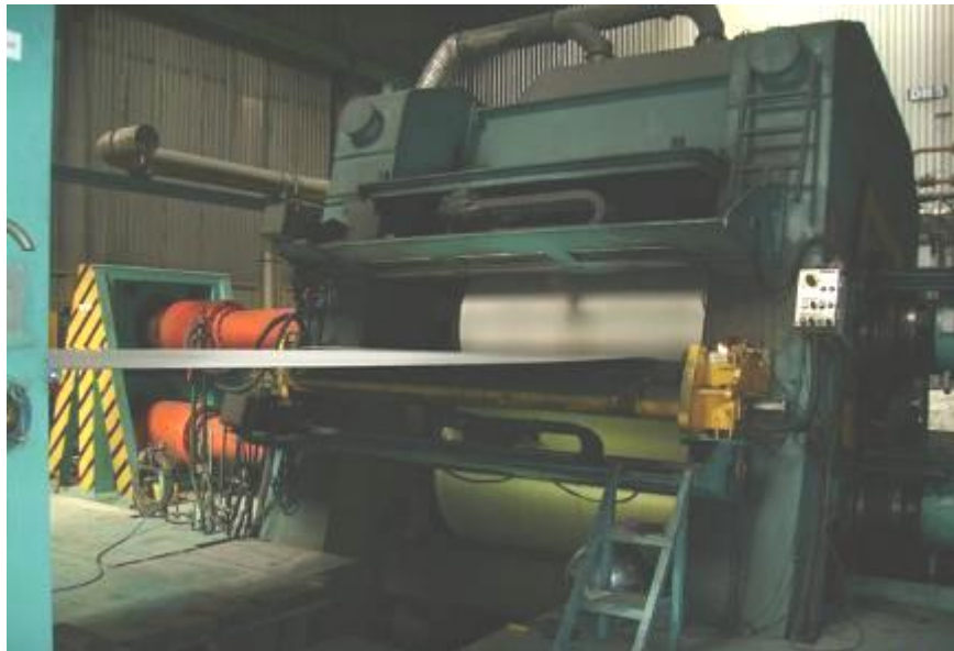
Şekil 3.10 Assan Alüminyum' un 5.Döküm Hattındaki Döküm makinası
