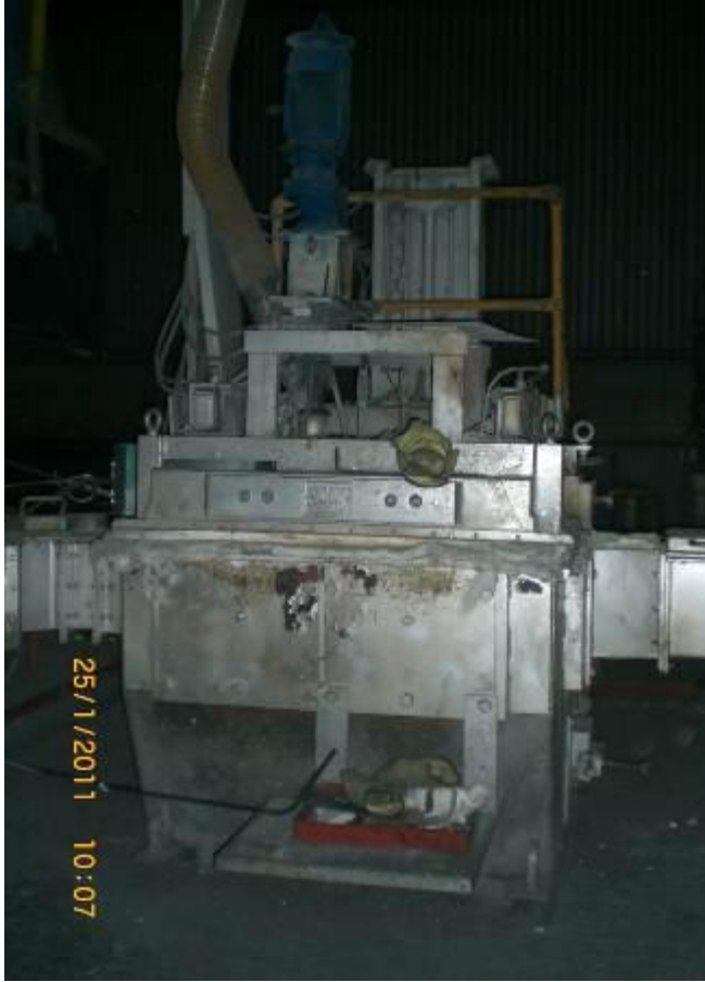
Şekil 6.3 Assan Alüminyum'daki Gaz Alma Ünitesi
