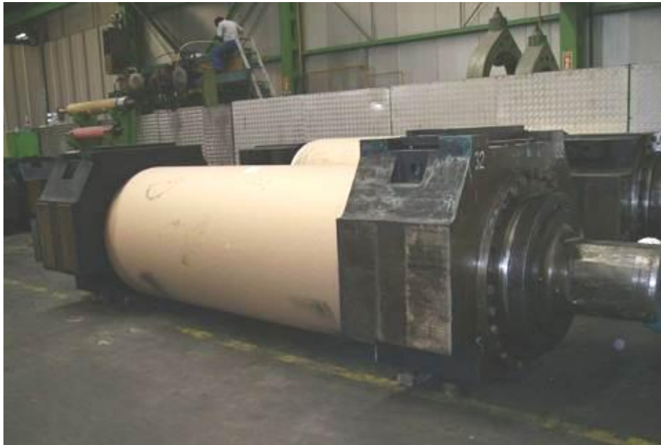
Şekil 3.8 Assan Alüminyum 5.Döküm hattında kullanılan merdane çiftleri
