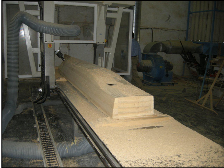
Şekil 3. 5 M 367 tekne modelinin ön imalat resmi
