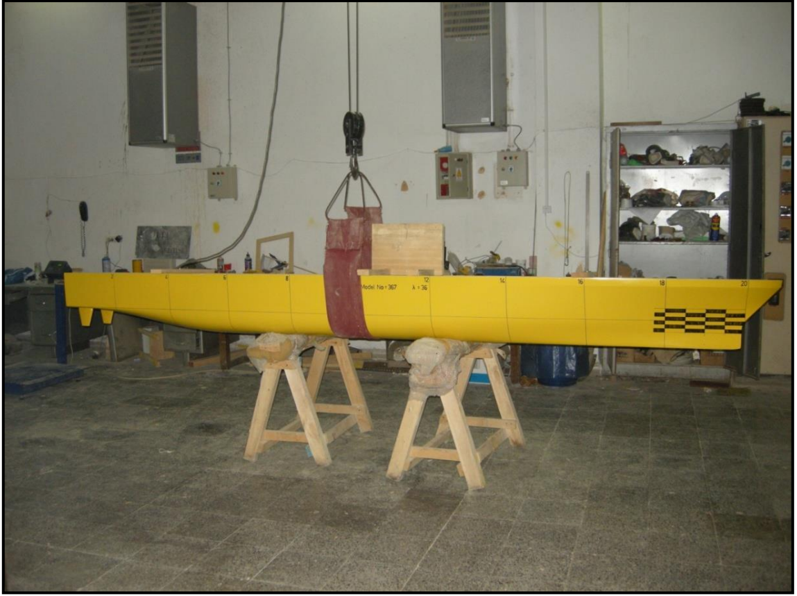
Şekil 3. 6 M 367 takıntısız modelin genel resmi
