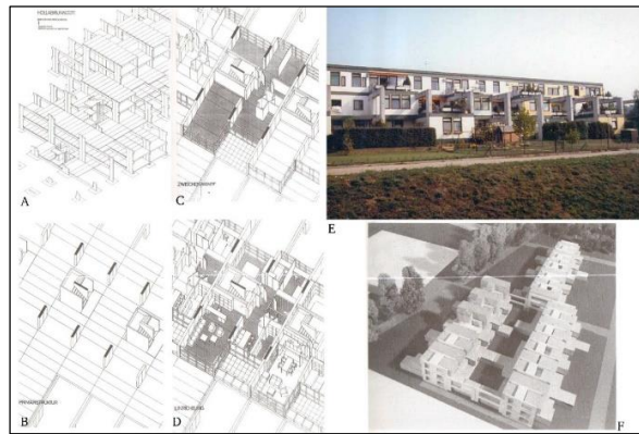
Şekil 2.24 Proje destek strüktür (A), ana strüktür (B), destek alt bölümler (C), birkaç birimde dolgu (D), görsel (E) [87], çalışma modeli (F) [12]
