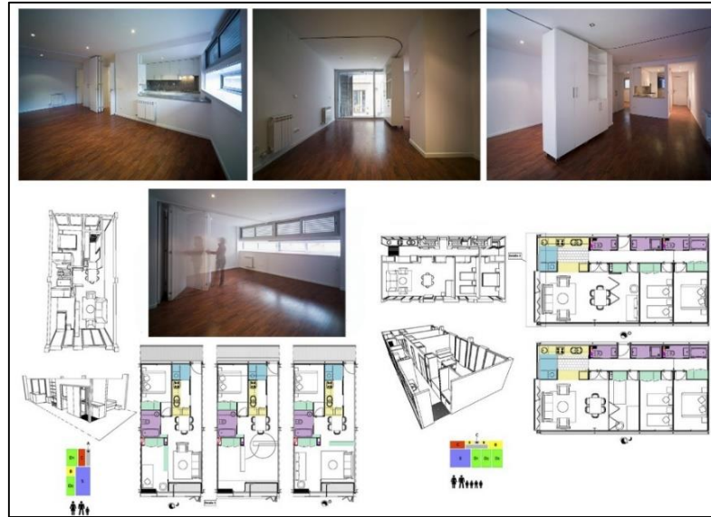
Şekil 2.35 Bölücü elemanlar ile desteklenen esnek konut örneği [105]
