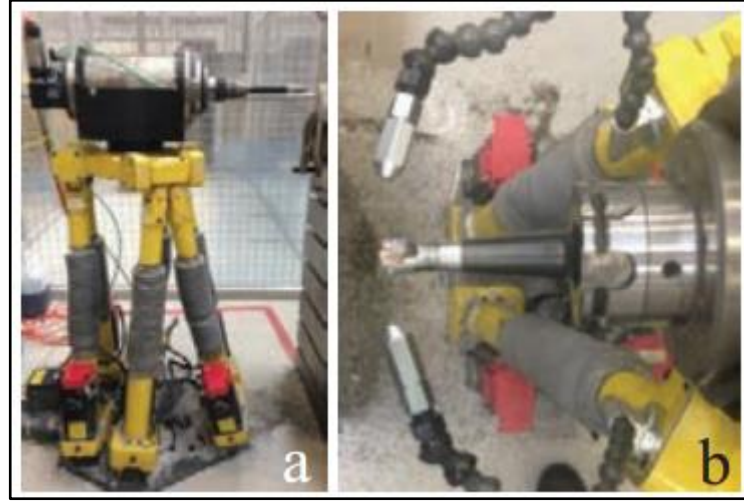
Şekil 1.4 MQL sistemi monte edilmiş robotik işleme ünitesi a) İş mili eklenmiş mobil işleme robotu b) MQL nozülleri [20]
