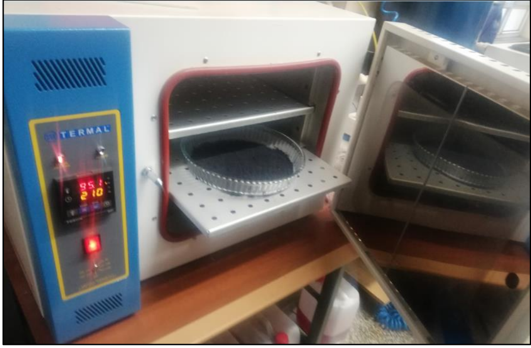
Şekil 3.12 MoS 2 kurutulması sırasında kullanılan etüv
