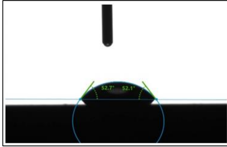
Şekil 1.18 Ganyometre ile MoS 2 katkılı damlacığın yüzey temas açısı ölçümü [71]
