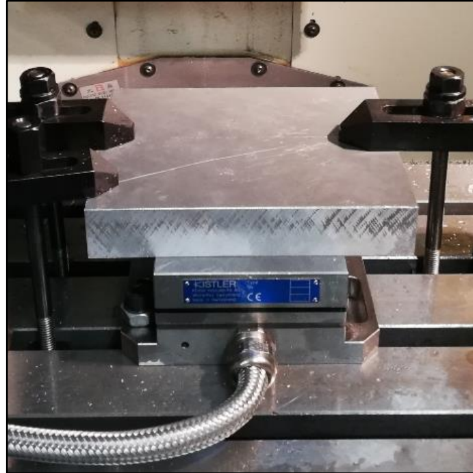
Şekil 3.9 Kuvvet ölçümlerinde kullanılan dinamometre
