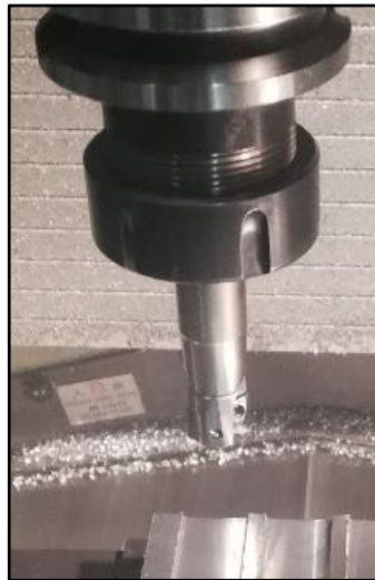
Şekil 3.2 Ø 16 mm takma uçlu freze
