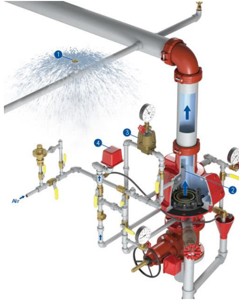
Şekil 3. 12 Kuru alarm vanası [27]
