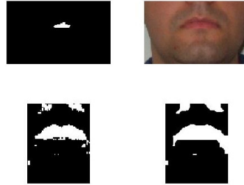
Şekil 4.16 Dudak bölgesinin bulunması için yapılan dönüşümler (a) YCbCr renk modeli ile dudakların bulunması (b) ağız bölgesi (c) RGB renk uzayı ile dudakların bulunması (d) medyan süzgeç ve kapatma işlemi uygulanması
