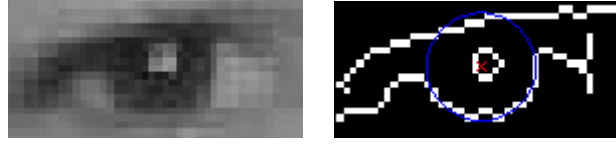
Şekil 2.10 Hough dönüşümü ile göz bebeğinin bulunması (a) Siyah beyaz göz görüntüsü (b) r=8 piksel alınarak bulunan göz bebeği
