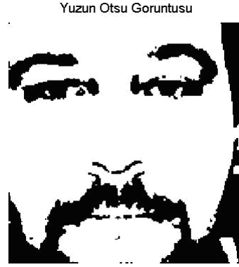
Şekil 4.6 Yüz görüntüsüne Otsu algoritmasının uygulanması
