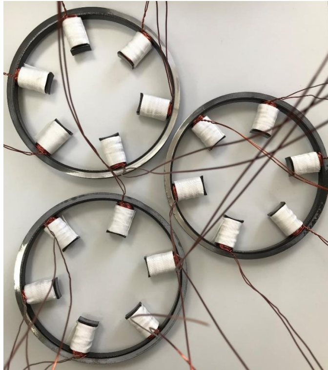
Şekil 5.1 Prototip küresel motorun stator yapısı
