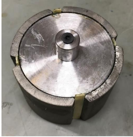
Şekil 5.2 Prototip küresel motorun rotor yapısı
