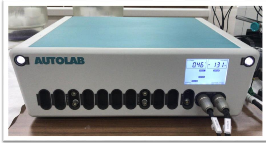
Şekil 3.6 Dönüşümlü voltametri ve diferansiyel puls voltametrisi çalışmalarında kullanılan Autolab PGSTAT128 N Potantiyostat/Galvanostat cihazı
