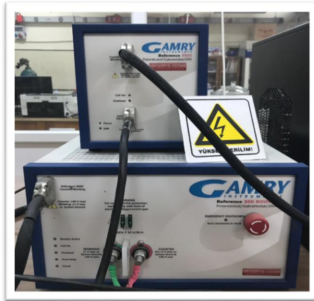
Şekil 3.7 Elektrokimyasal empedans spektroskopisi ve dönüşümlü şarj deşarj testleri çalışmalarında kullanılan Gamry Reference 3000 Potantiyostat/Galvanostat cihazı
