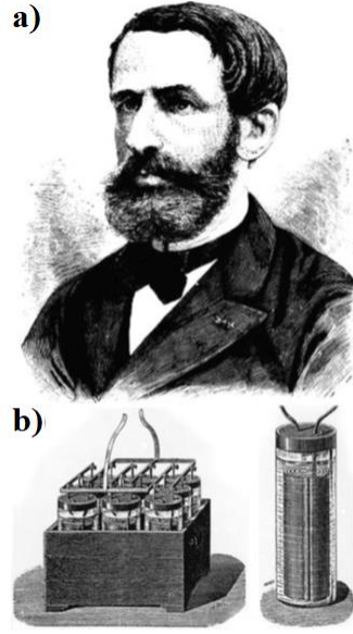
Şekil 2.3 a) Gaston Plante'nin Portresi ve b) paralel bağlanmış bir dizi dokuz hücre içeren ilk şarj edilebilir kurşun asit batarya
