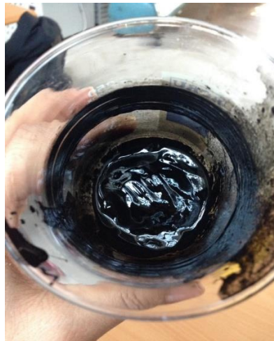
Şekil 3.21 MWCNT-su (%0,7, hacimsel) nanoakışkanının çökelme testleri
