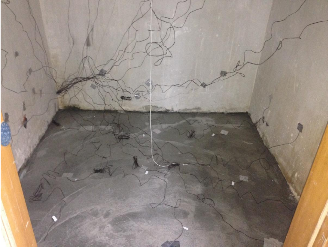
Şekil 3.19 Test odasına ısı çifti yerleştirilmiş görünümü
