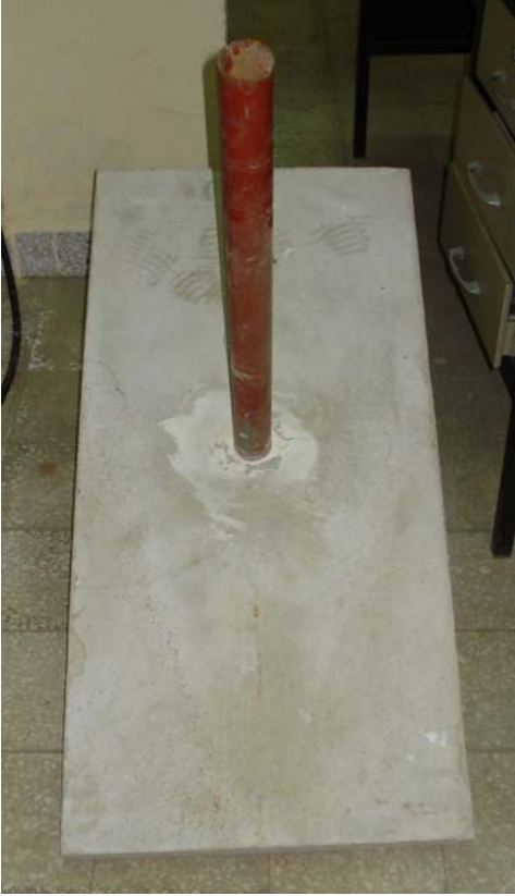
c) Duvar jeti deneyleri için oluşturulan rijit taban
