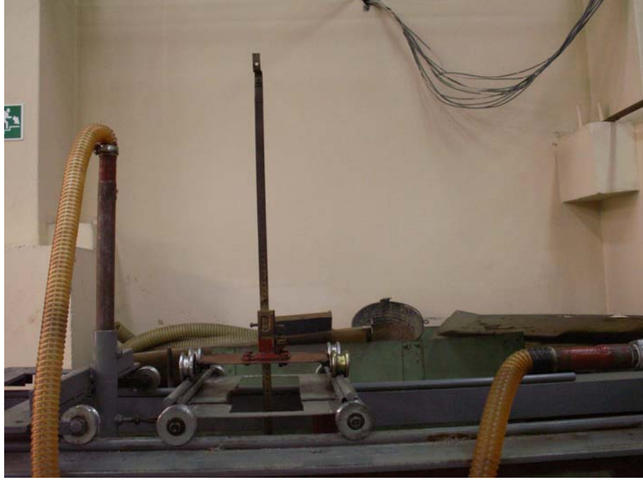
d) Deney sisteminde ADV ve limnimetrenin yerleştirildiği hareketli tabla
