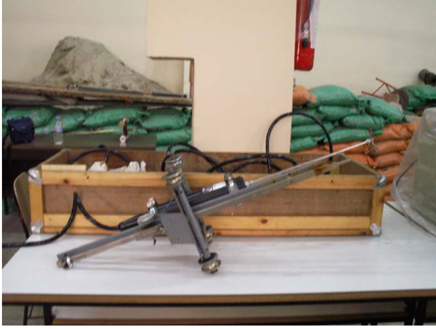
b) Deneylerde kullanılan ADV aşağı bakan prob
