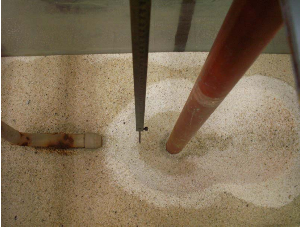
e) Hareketli tabanda kazık etrafında oluşan oyulma profilinin limnimetre ile belirlenmesi
