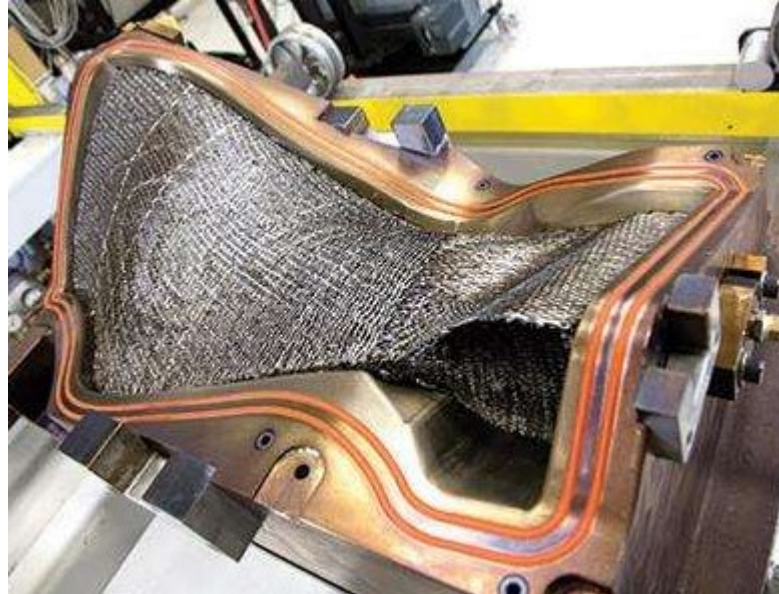
Şekil 3.11 Karbonfiber fan kanat kalıbı
