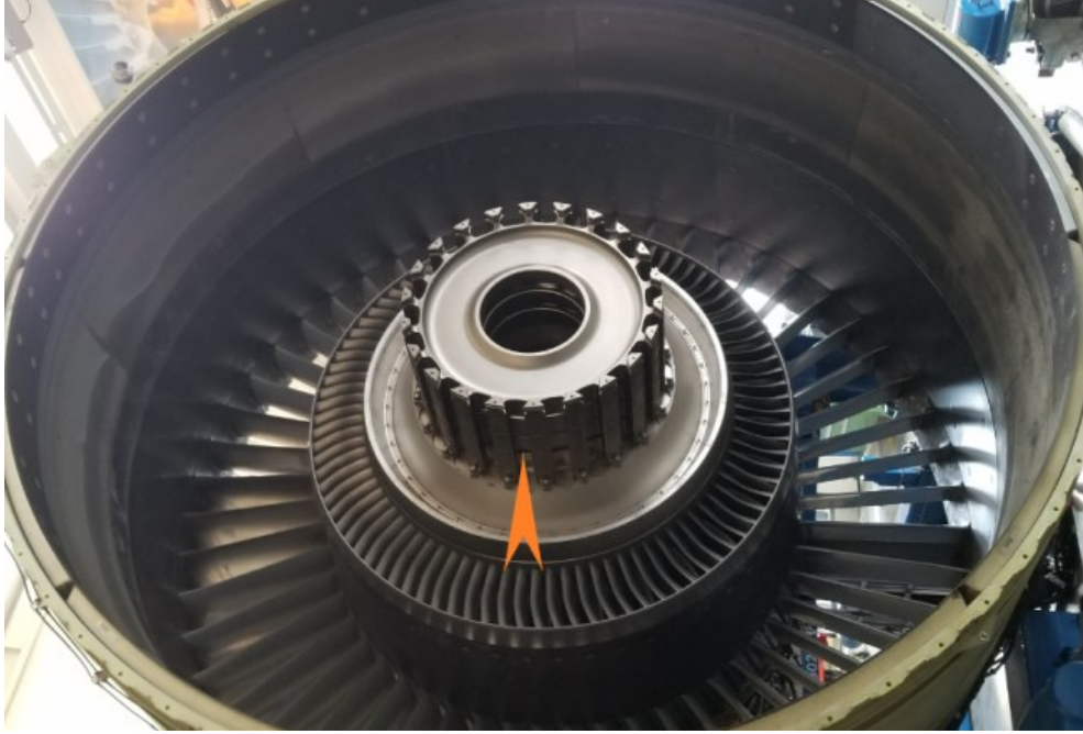
Şekil 5.12 Fan kanatları sökülmiş olan disk, fan kanat yuvası
