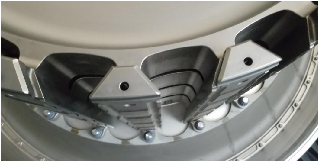
Şekil 5.19 Fan disk üzerinde fan kanat yuvaları
