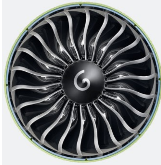
Şekil 3.19 GE90-115B Fan kanat simetrik montaj işlemleri
