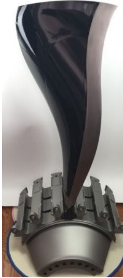
Şekil 3.18 Fan kanat motor diski montaj noktası
