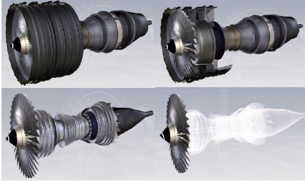
Şekil 3.13 Fan kanatlarının motordaki konumu
