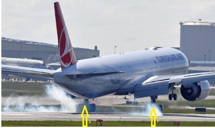
Şekil 2.3 Uçak tekerlek koyma anı etki kuvvetleri
