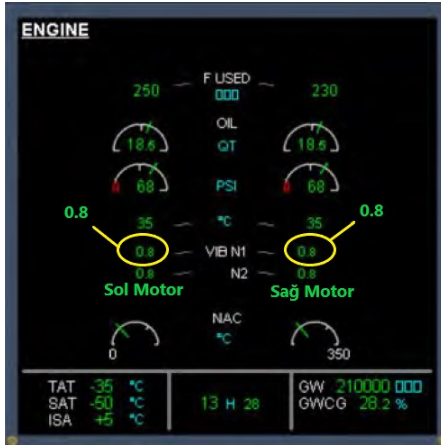
Şekil 5.5 ECAM motor titreşim değerleri ekranı
