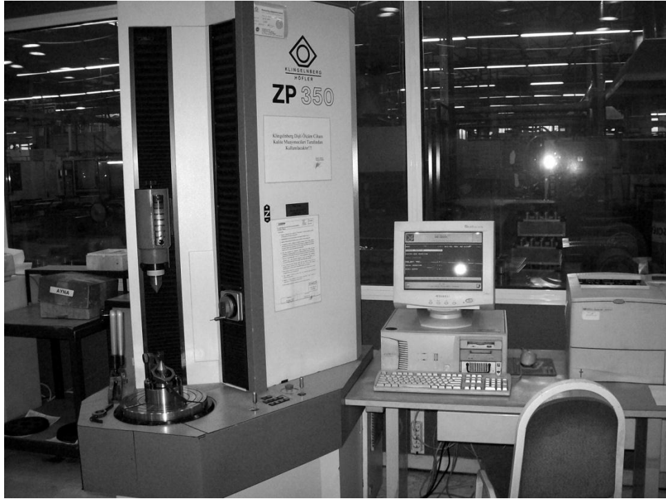
Şekli 6.8 Klingelberg ZP350 üç boyutlu dişli ölçme cihazı
