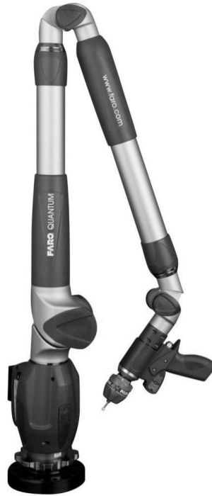
Şekil 7.1 Faro Quantum çok eksenli 3 boyutlu ölçme kolu
