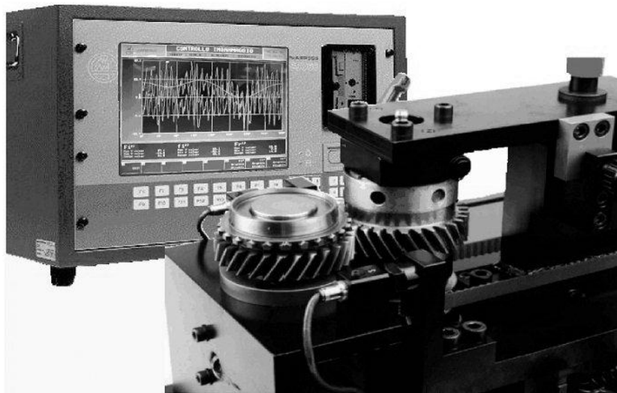
Şekil 6.3 Diřli hatalarının master diřli yardımı ile tespiti
