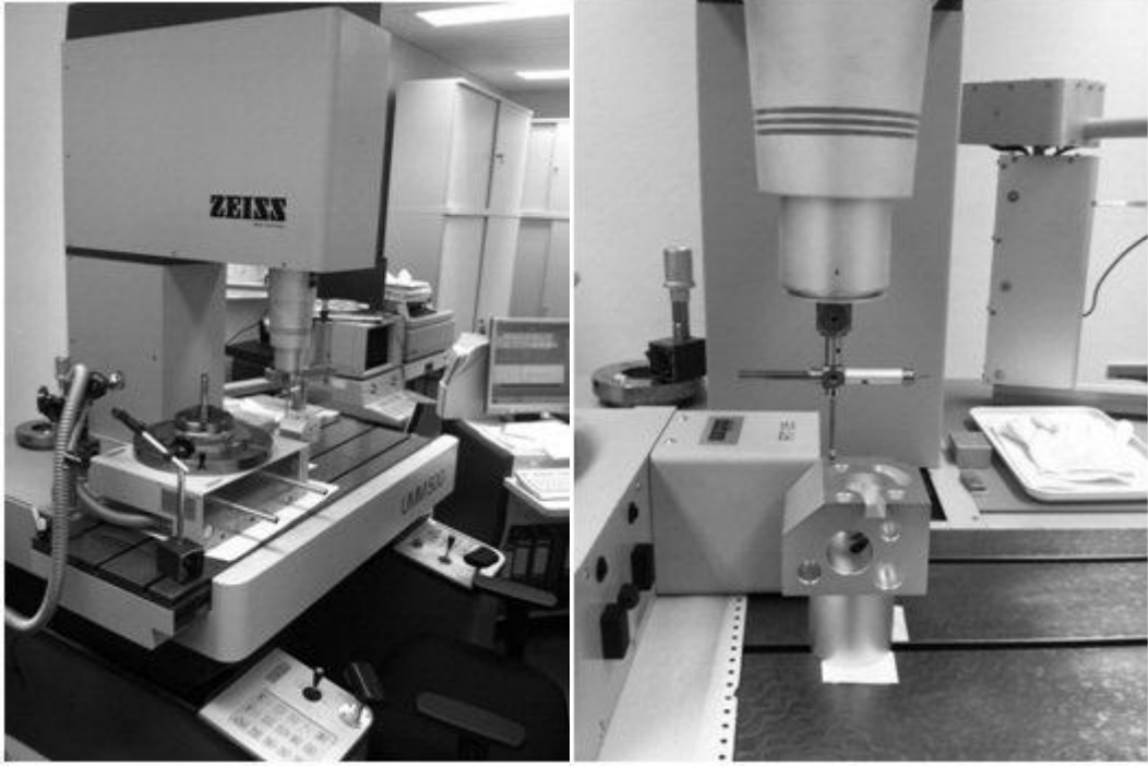
Şekil 5.11 Koordinat ölçme cihazı ile ölçme işlemi
