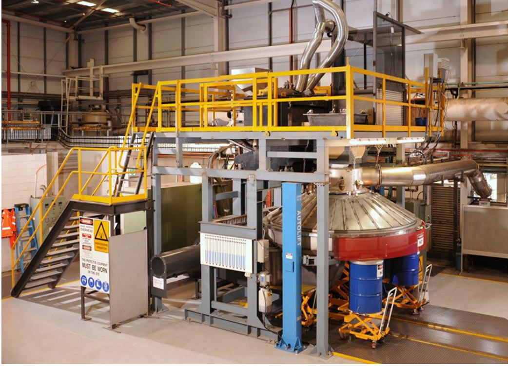
Şekil 1.18 CSIRO'daki yarı endüstriyel ölçekte (3 m çapında) entegre ısı geri kazanım ve kuru granülasyon pilot tesisi [11]
