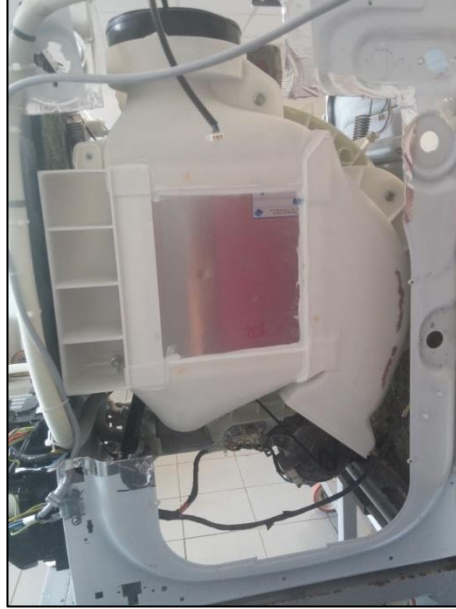
Şekil 4. 99 Final prototip kondanser grubu montaj hali
