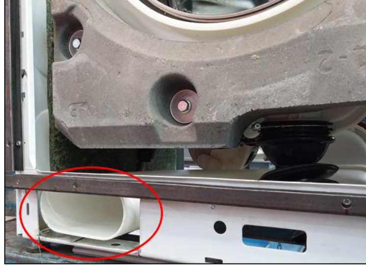
Şekil 4. 69 Kondanser soğutma grubu soğuk hava girişi
