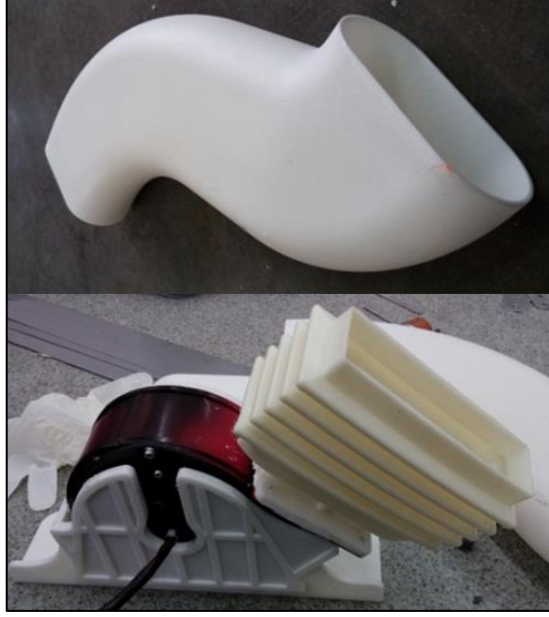
Şekil 4. 65 Kondanser soğutma grubu
