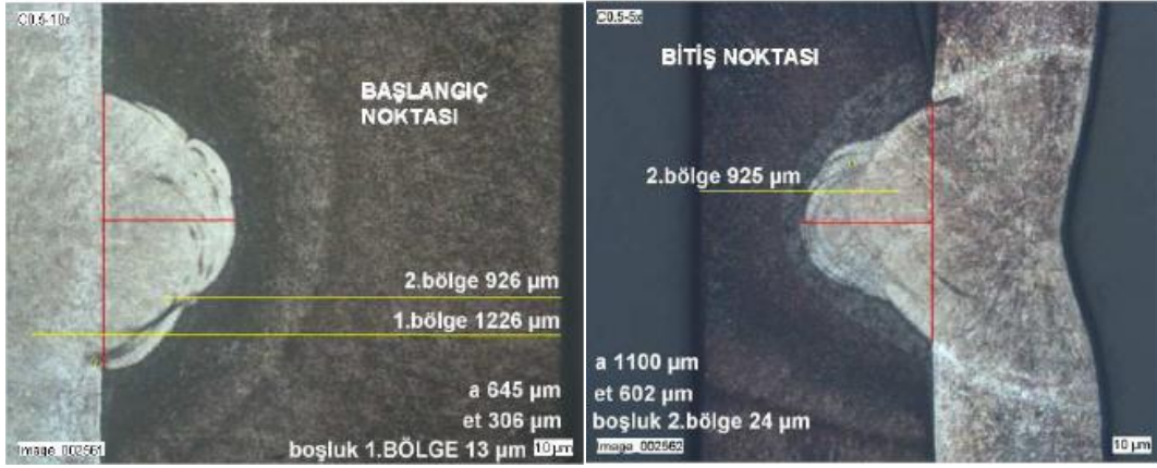
Şekil 6.35 Kaynak hızı 0,6 s olan VS-VH parçasının sağ ve sol dikey metalografi görüntüsü
