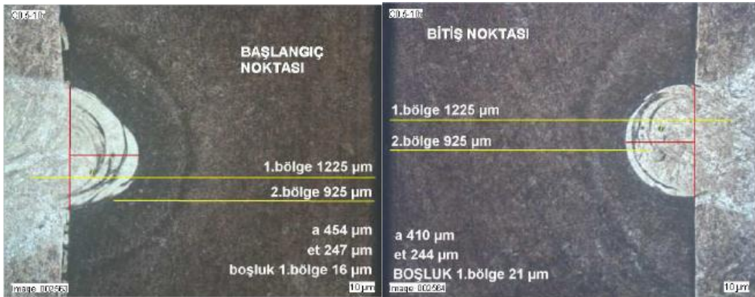
Şekil 6.36 Kaynak hızı 1,8 s olan VS-VH parçasının sağ ve sol dikey metalografi görüntüsü
