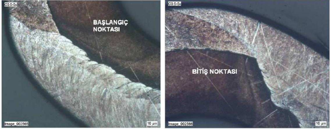
Şekil 6.37 Kaynak hızı 0,6 s'ye düşürülmüş VS-VH parçasının dikey ve yatay kesilmiş metalografi görüntüleri
