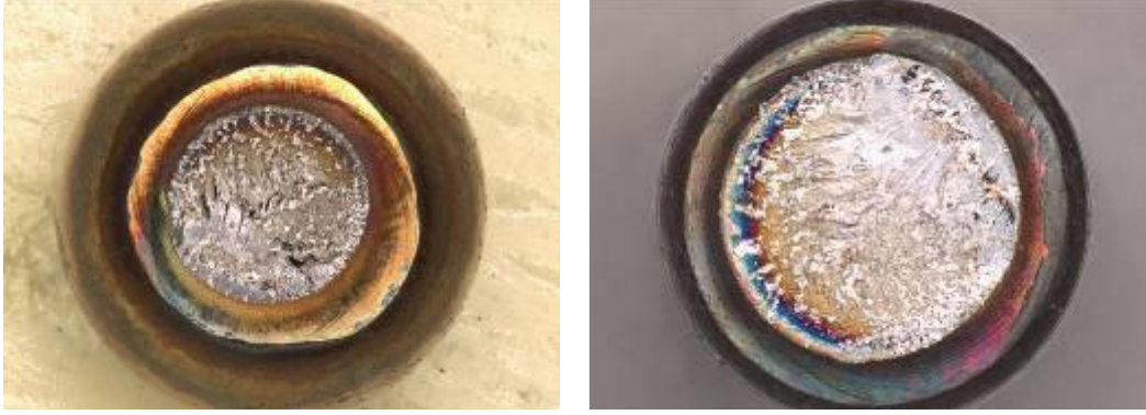
Şekil 6.14 KGL ve VN çatlaklı parçanın yüzeyleri
