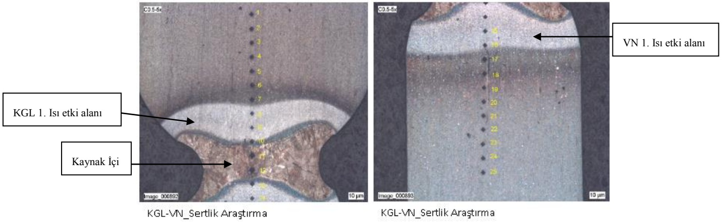
Şekil 6.10 KGL-VN kaynak birleşmiş parçanın sertlik ölçümü alınan 25 bölgesi
