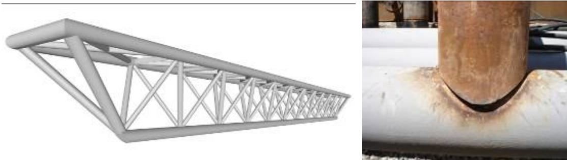
Şekil 3.16 Uzay kafes kiriş modeli ve düğüm noktası gazaltı kaynak tekniği [45]
