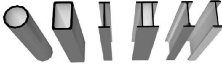
Şekil 3.24 Dolu gövdeli çelik kolonlarda enkesit tipleri
