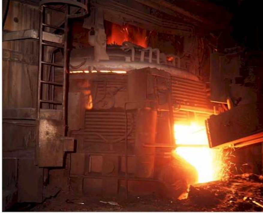
Şekil 2.7 Bir harmonik kaynağı olan ark fırını (Cemtaş Katalog).
