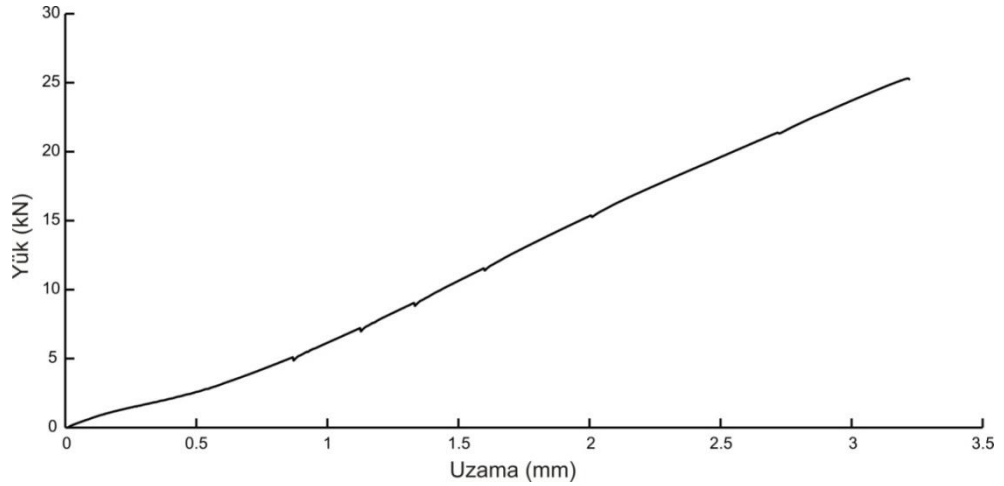
Şekil 7.29 AV138+2015 hibrit yapıştırırmalı bağlantı ( \xi = 0.7 ) yük-uzama eğrisi
