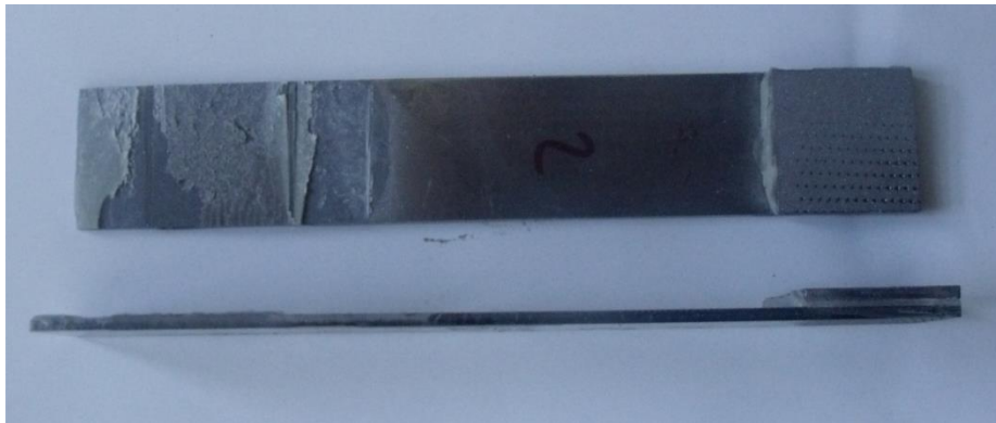
Şekil 7.23 Hasar uğrayan hibrit yapıştırmalı bağlantı
