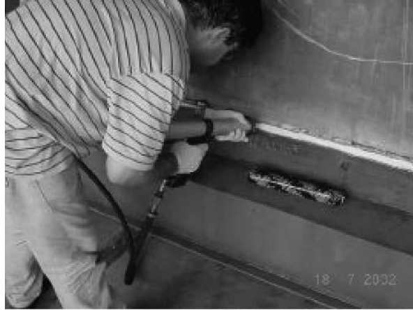
Şekil 3.6 Alüminyum üst güverte ile çelik gövde arasında yapıştırıcı kullanılması [29]
