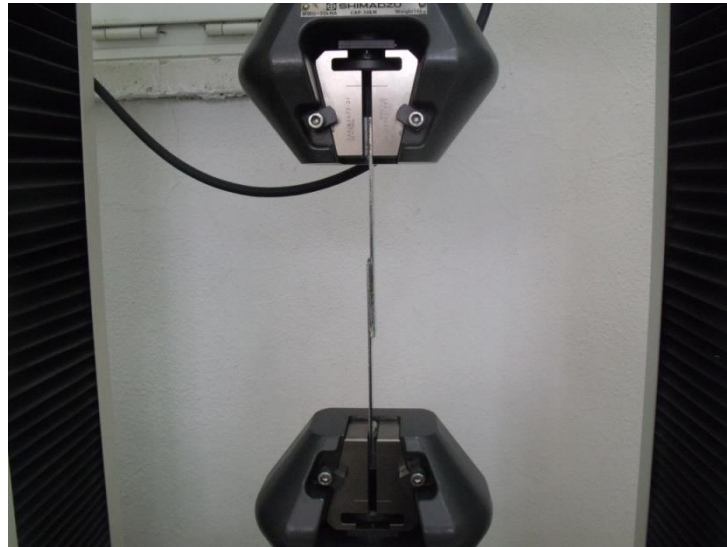
Şekil 7.22 Bindirmeli bağlantı çekme test cihazı çene bağlantısı
