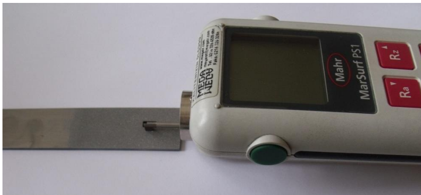
Şekil 7.13 Kumlama yüzeyi pürüzlülük ölçümü yüzey taraması
