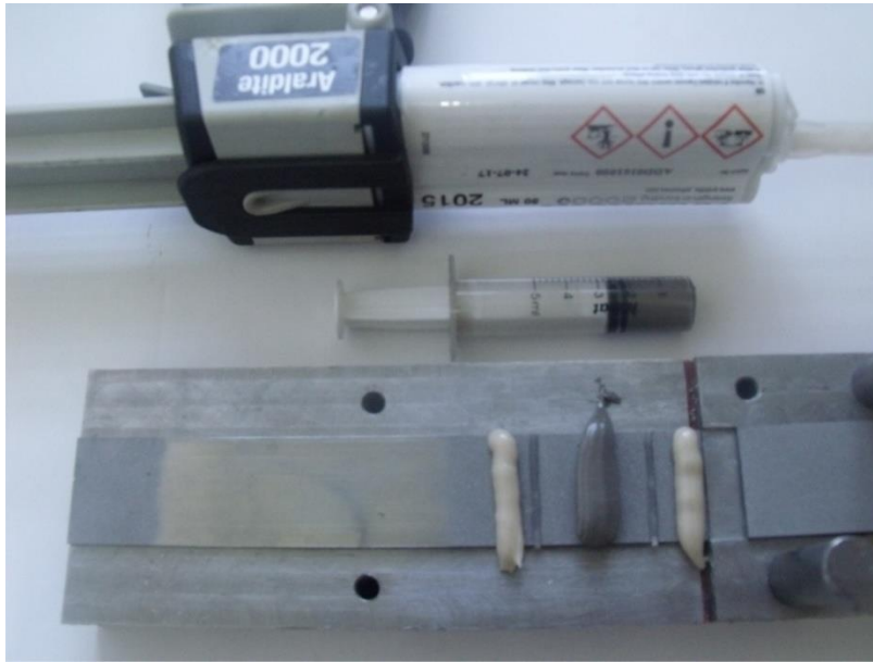
Şekil 7.16 Hibrit yapıştırırmalı bağlantının hazırlanması
