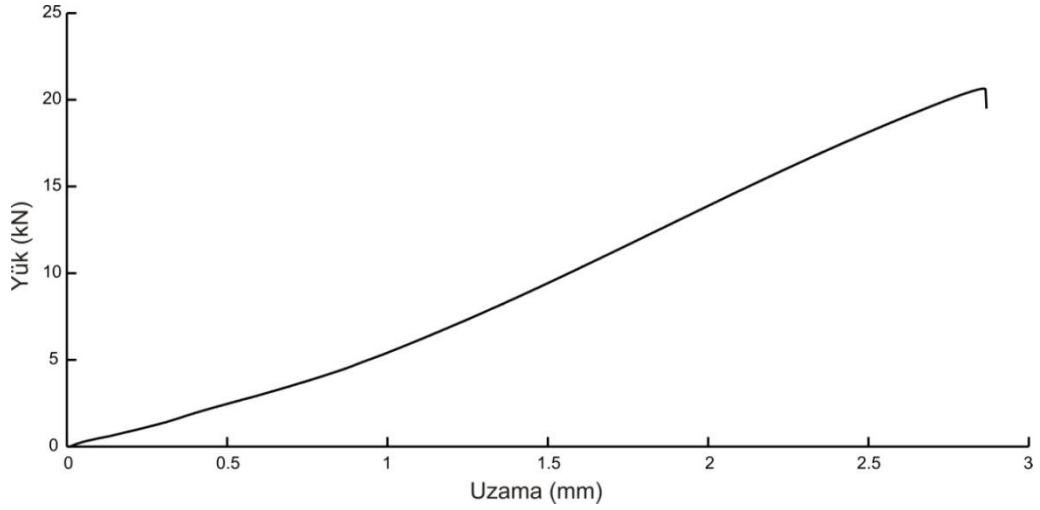
Şekil 7.31 AV138+DP-8005 hibrit yapıştırırmalı bağlantı ( \xi = 0.5 ) yük-uzama eğrisi
