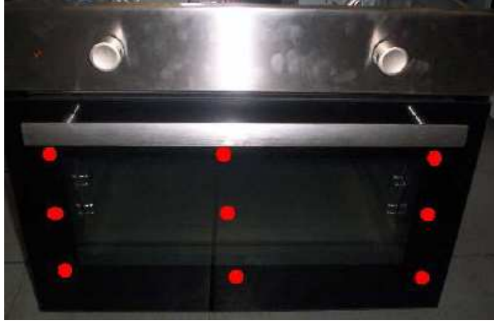
Şekil 3.15 Dış cam sıcaklık ölçüm noktaları
