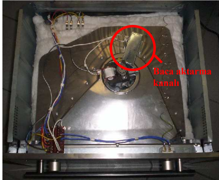
Şekil 3.10 Pişirici havalandırma sisteminin üstten görünüşü
