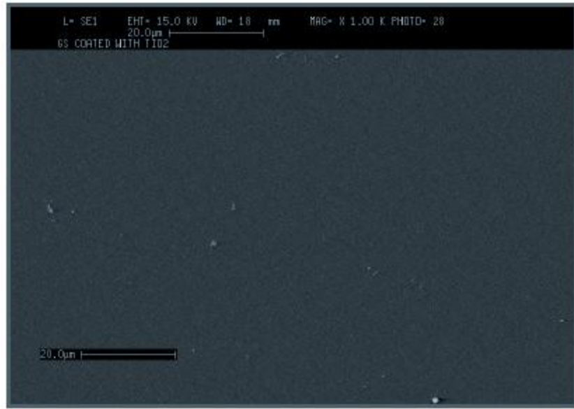
Şekil 1.10 Cam üzerine kaplanmış \text{TiO}_2 ince filmlerin SEM analizi.
