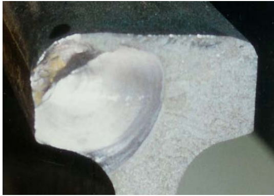
Şekil 6.2 Ray mantarında yorulma hasarı [51].
