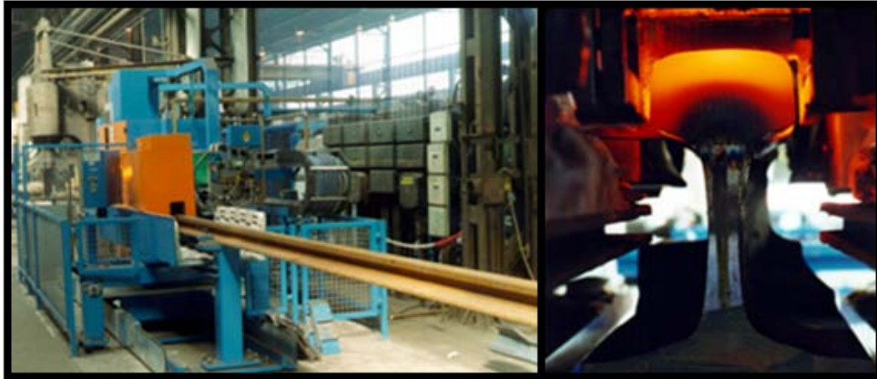
Şekil 4.7 “Off-line” tipi su verme sistemi [38].
