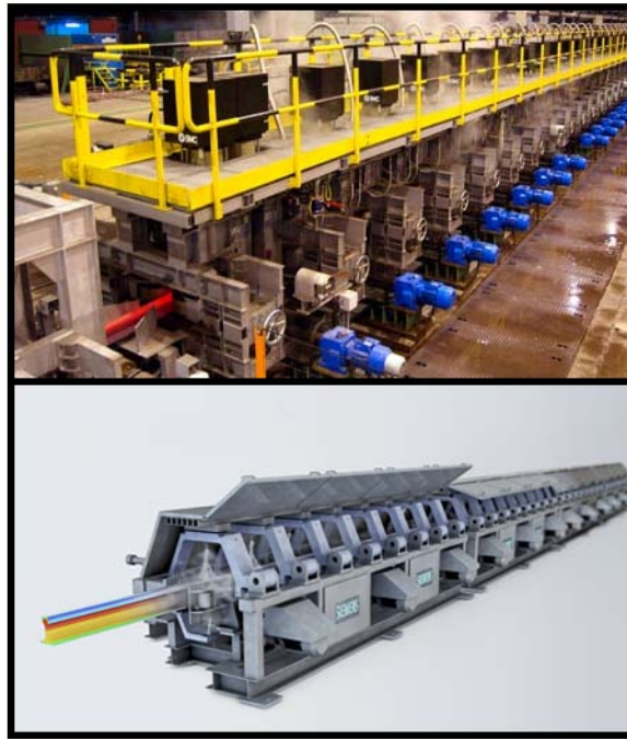
Şekil 4.6 “In-line” tipi su verme sistemi [38].
