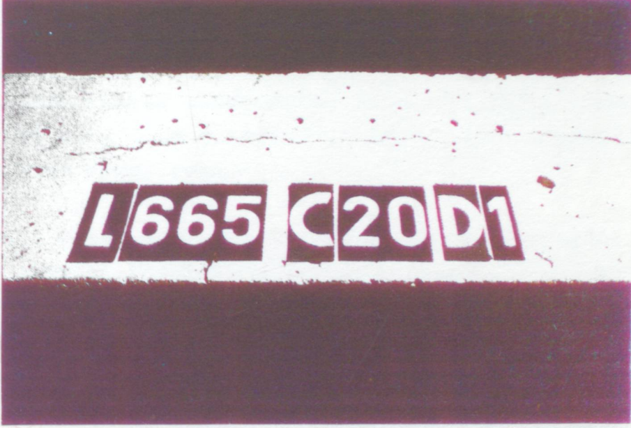
Fotoğraf 8.4 Korozyon nedeniyle oluşan boyuna çatlak [22]
