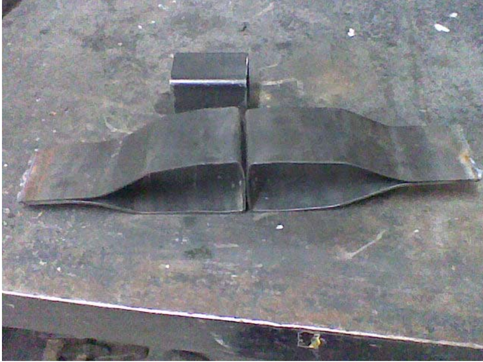
Şekil 6.19 3 no'lu malzeme çiftinin çekme deneyine uygun hale getirilmesi
