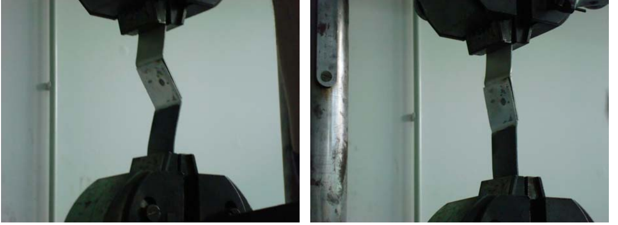
Şekil 6.20 Çekme deneylerinin gerçekleştirilmesi
