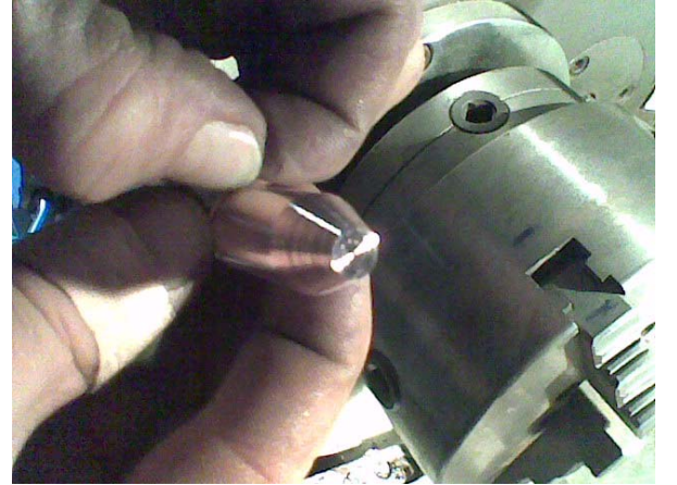
Şekil 6.13 Elektrotların istenen forma getirilmesi
