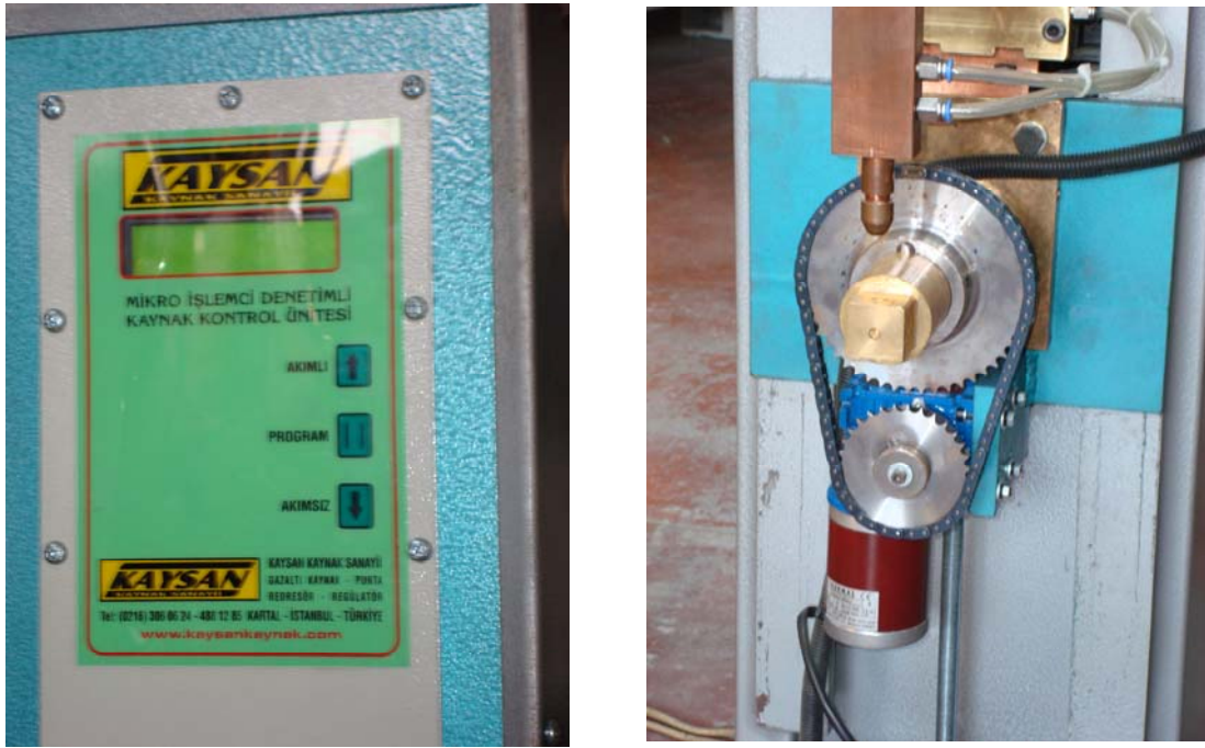
řekil 6.8 Deneylerde kullanılan nokta direnç kaynak makinesi
