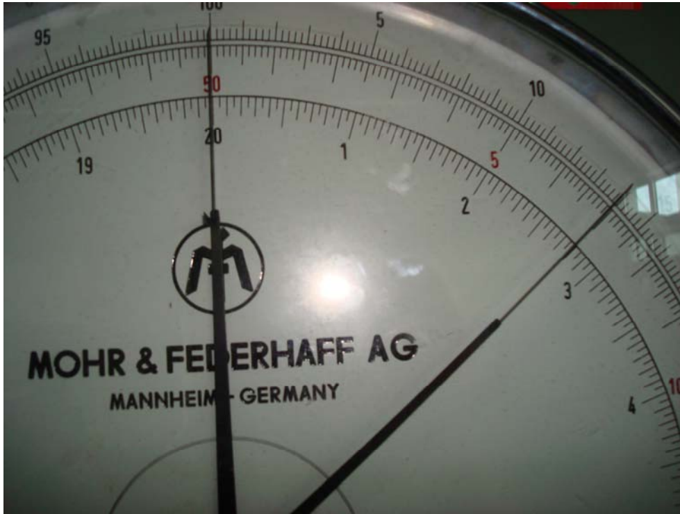
Şekil 6.21 Kopma kuvveti değerlerinin okunması
