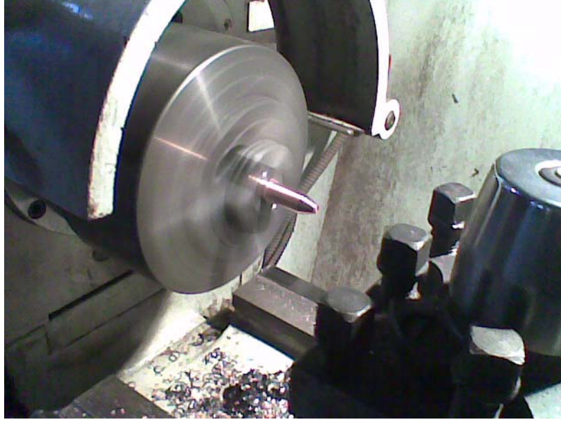
Şekil 6.12 Cu-Zr esaslı elektrotların 8 mm'lik basma çapına getirilmesi
