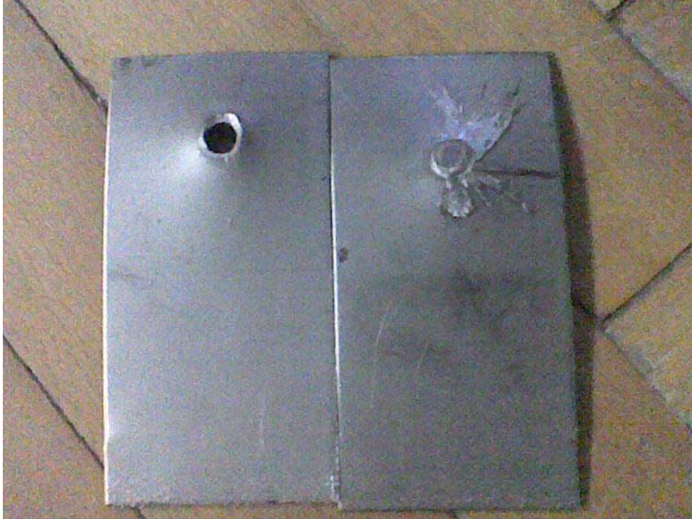
Şekil 7.5 1. konstrüksiyon paslanmaz çelik malzeme çiftinin kopma şekli
