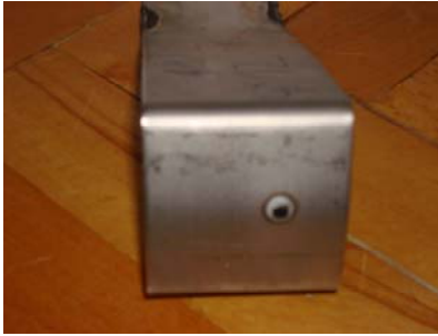
Şekil 7.3 48 kVA'lık güç değerinde yetersiz kaynak birleşmesi
