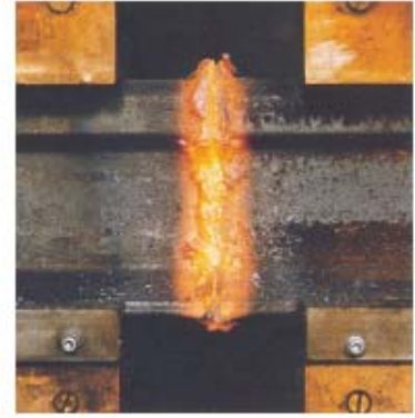
Şekil 2.8 Direnç alın kaynak makinesi ve kaynak bölgesi detayı
