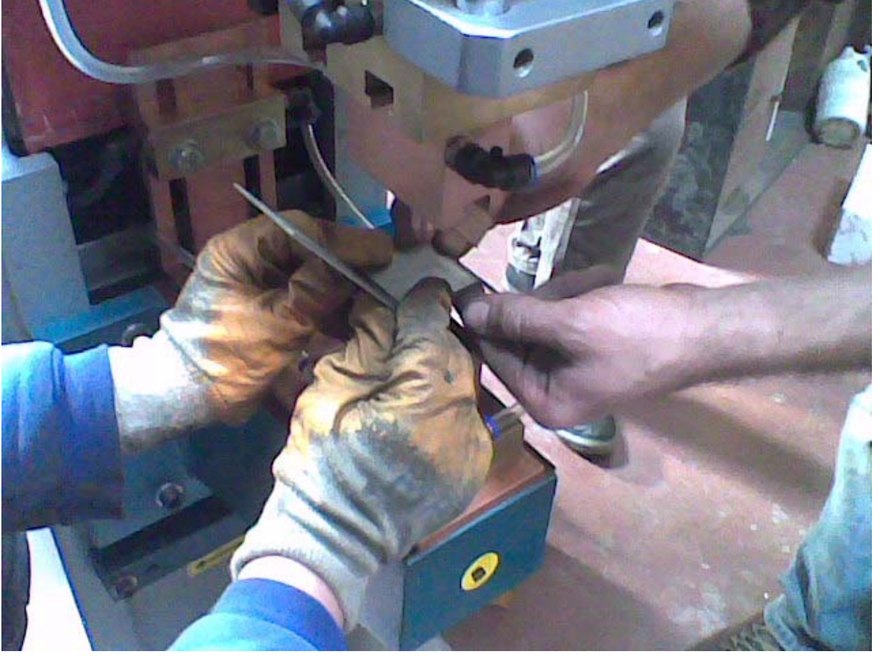
Şekil 6.16 Aynı malzeme çiftinin kaynak bağlantılarının oluşturulması
