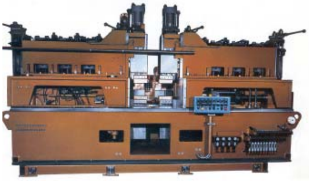
Şekil 2.8 Direnç alın kaynak makinesi ve kaynak bölgesi detayı
