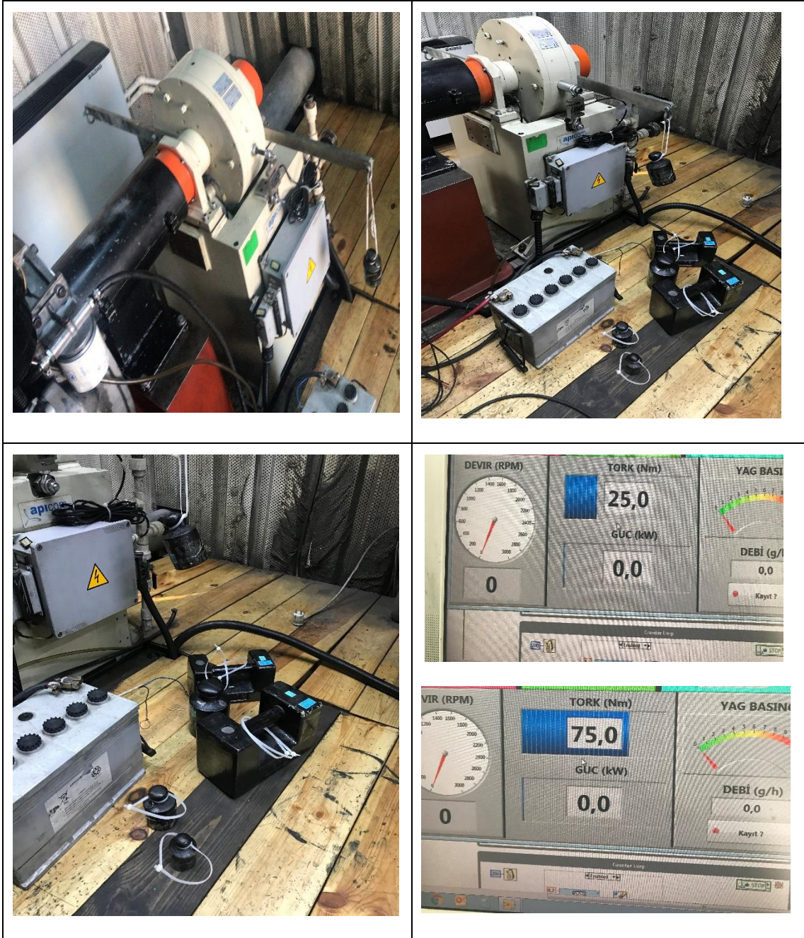
řekil 3.24 Dinamometre kalibrasyonu
