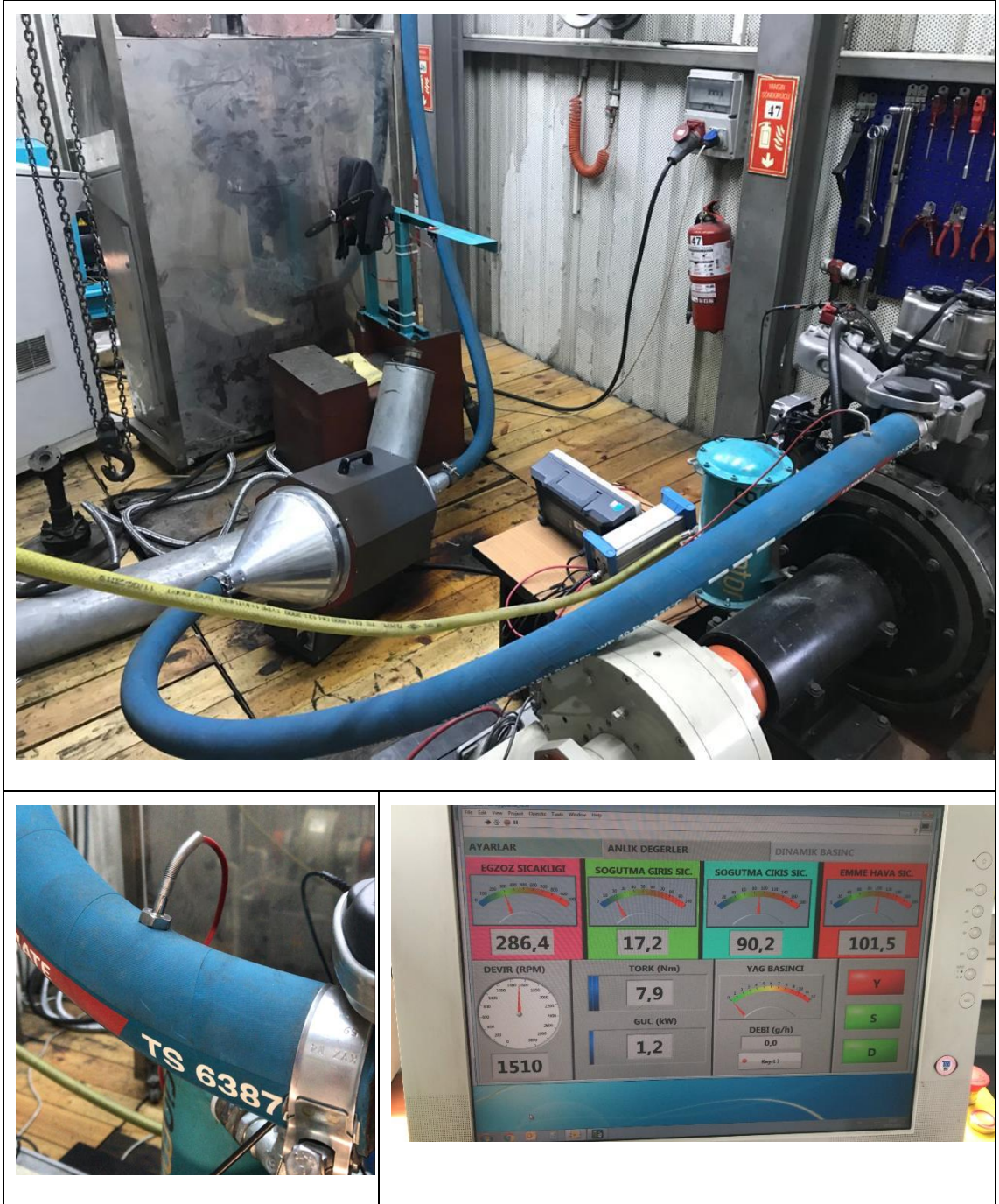
Şekil 3.23 Emme havası ısıtılarak yapılan çalışma için yapılan sistem
