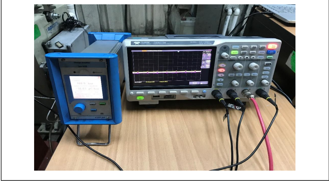
Şekil 3.15 (devamı) Silindir içi gaz basıncı ölçüm sistemi
