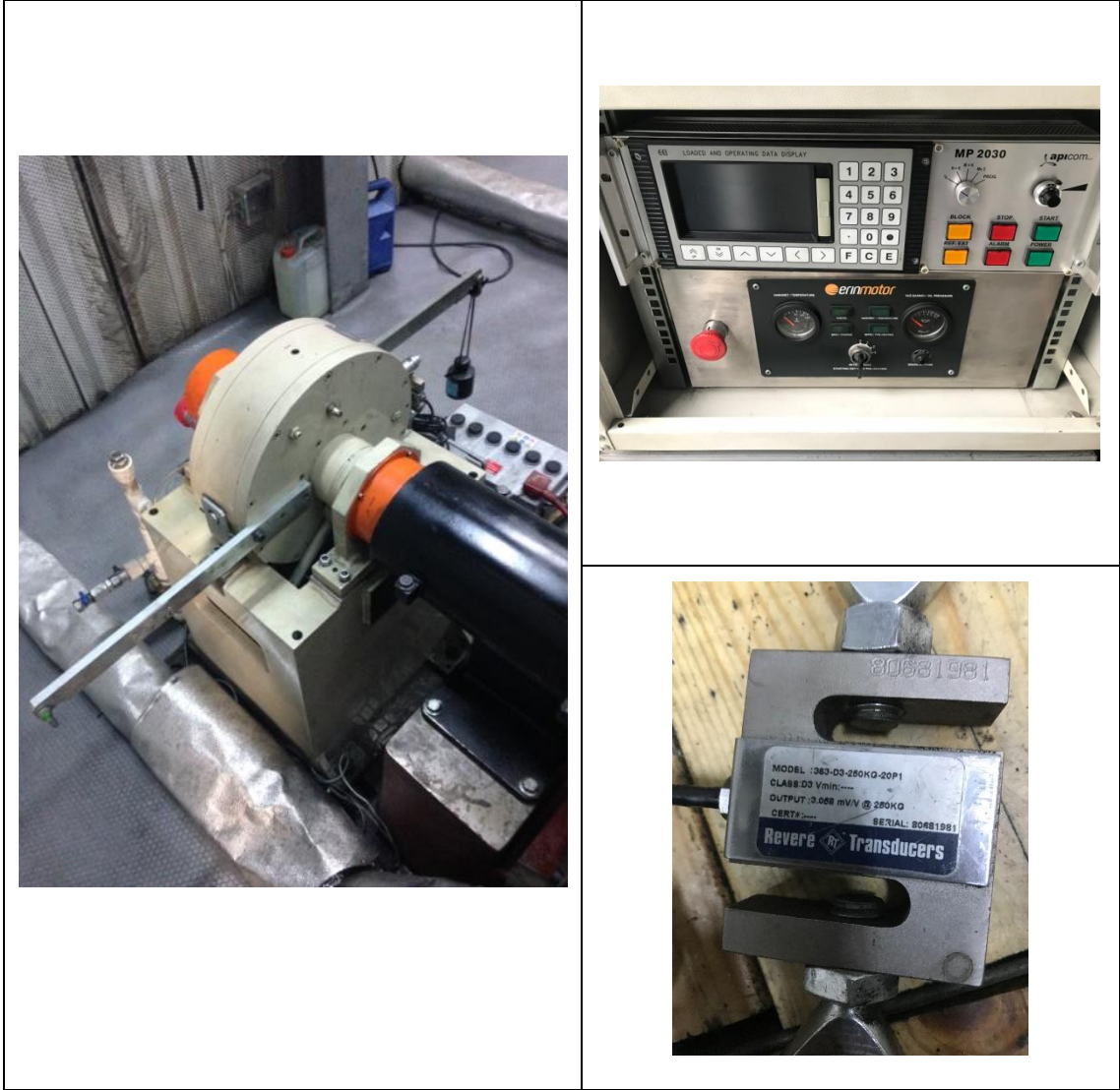
Şekil 3.9 ApiCom eddy current dinamometre, kontrol ünitesi ve yük hücresi
