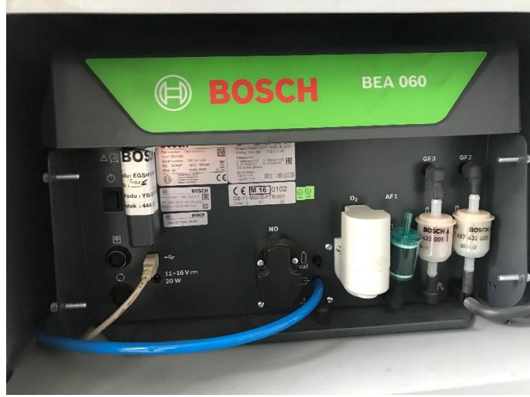
Şekil 3.17 Bosch BEA 060 egzoz emisyonu ölçer
