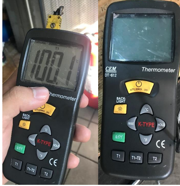
Şekil 3.25 Sıcaklık sensör kalibrasyonu
