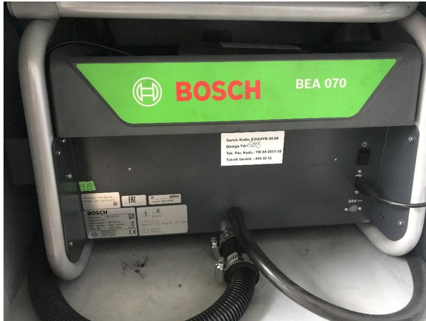
Şekil 3.18 Bosch BEA 070 is emisyonu ölçer
