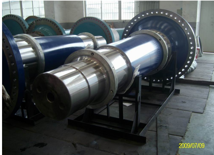
Şekil 4. 7 1,5 MW. Gücündeki bir rüzgar türbininin saftı
