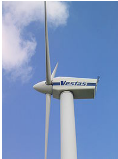
Şekil 4. 3 Yatay eksenli bir rüzgar türbini
