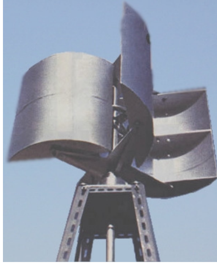
Şekil 4. 1 Savonius rüzgar türbini ve yapısı.
