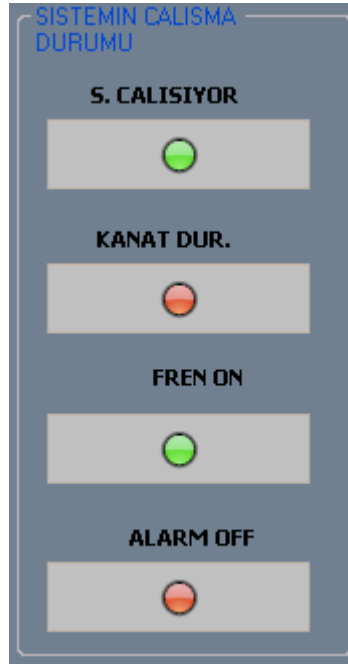
Şekil 11. 29 Sistemin röleler üzerinden kumandasının ekran üzerinden gösterimi
