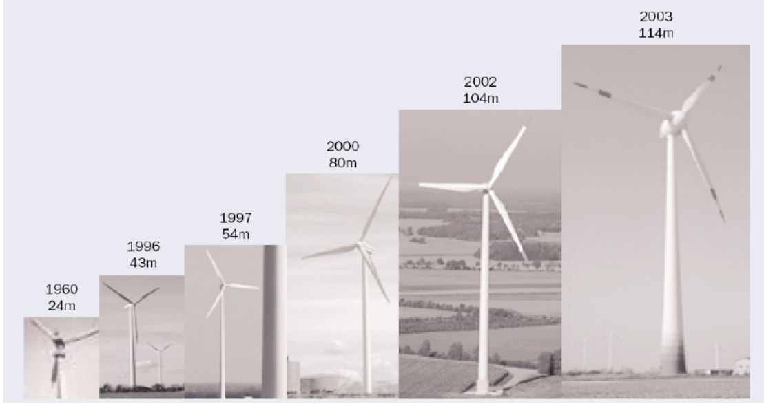
Şekil 4. 11 Türbin boyutlarının tarihsel olarak gelişimi.
