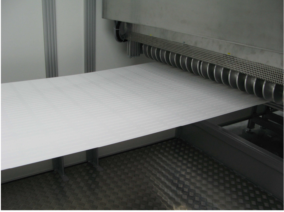
Şekil 3.10 Hotmeltlerin kağıda sürülmesi
