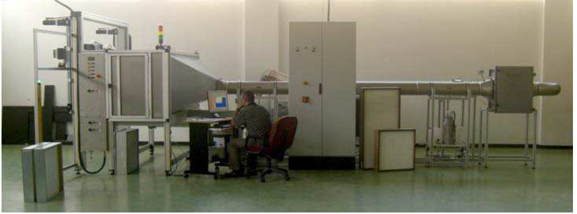
Şekil 3.23 EN 1822 testi için kullanılan otomatik tarayıcı test cihazı
