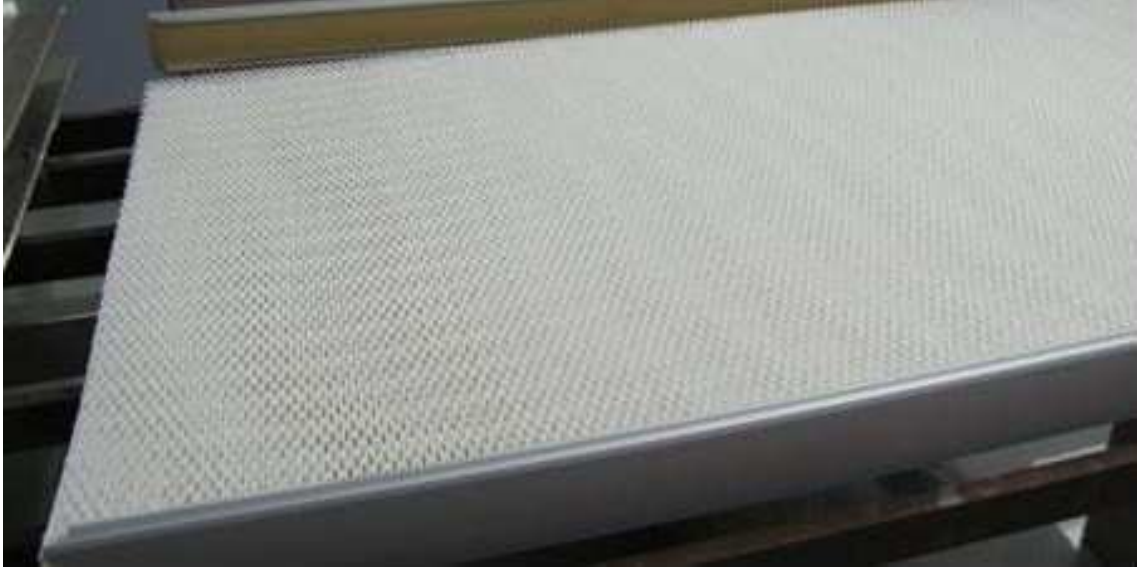
Şekil 3.14 Çerçevenin ızgaralı HEPA filtre kekine montajı
