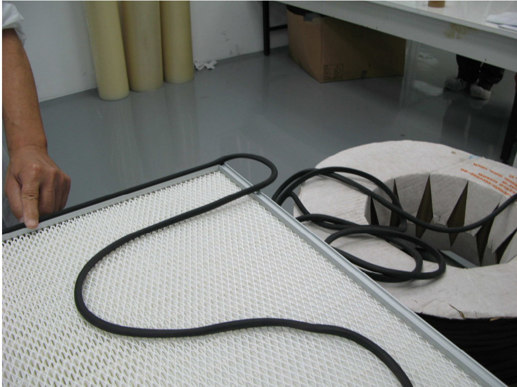
Şekil 3.15 Contanın filtreye yapıştırılması
