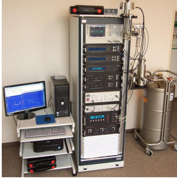
řekil 3. 4 Frekansa ve sıcaklıęa baęlı empedans analizr deney dzeneęi.
