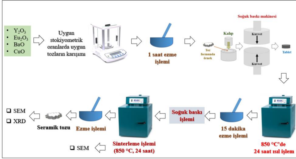
Şekil 3. 1 Numune hazırlama adımları.
