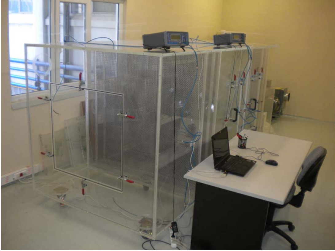
Şekil 5.4 Fan test tünelinin tüm elemanlarıyla genel görünüşü
