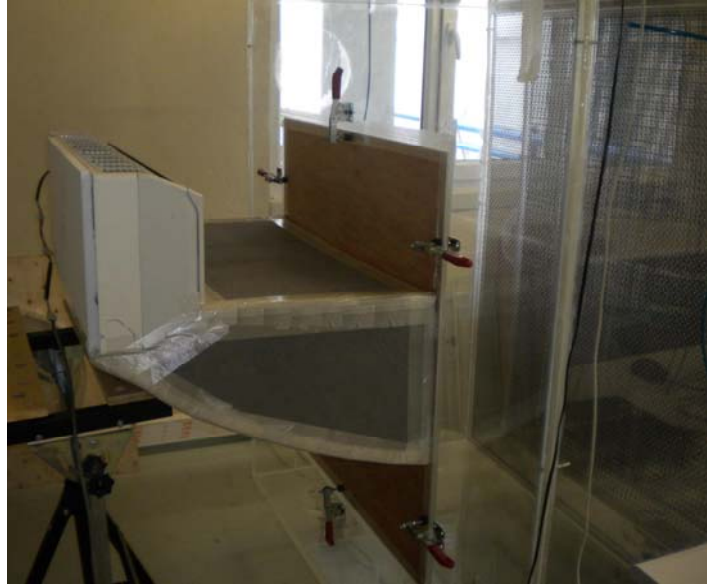
Şekil 7.4 Klima iç ünitesinin fan test tüneline bağlanması
