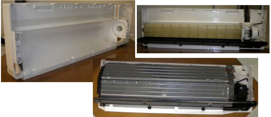
Şekil 7.3 Fan, fan motoru, dil ve eşanjörün şase üzerine yerleştirilmiş hali
