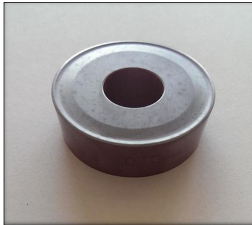
Şekil 4.2 Deneylerde kullanılan RCMX3209MO yuvarlak kesici uç
