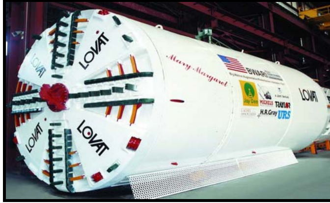
Şekil 4.1 Tipik bir çamur şiltli TBM
