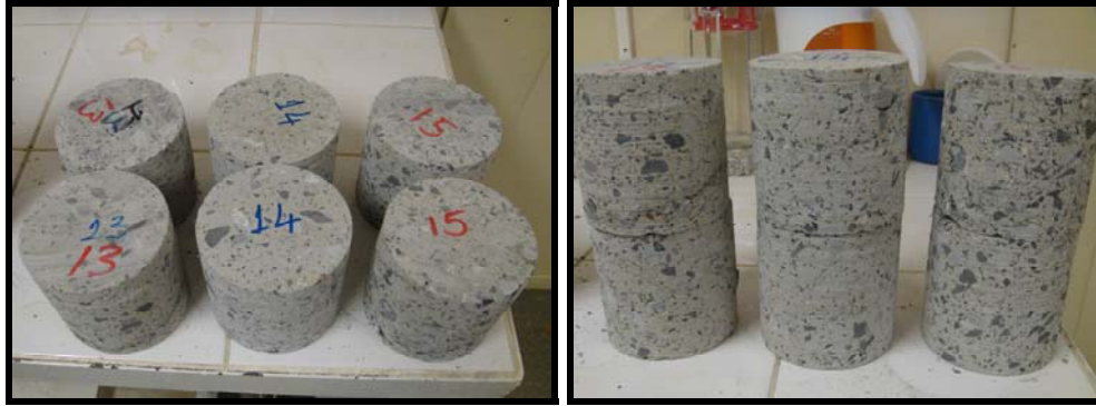
Şekil 4.6 Panellerden alınan silindir karot numunelere ait görünüm
